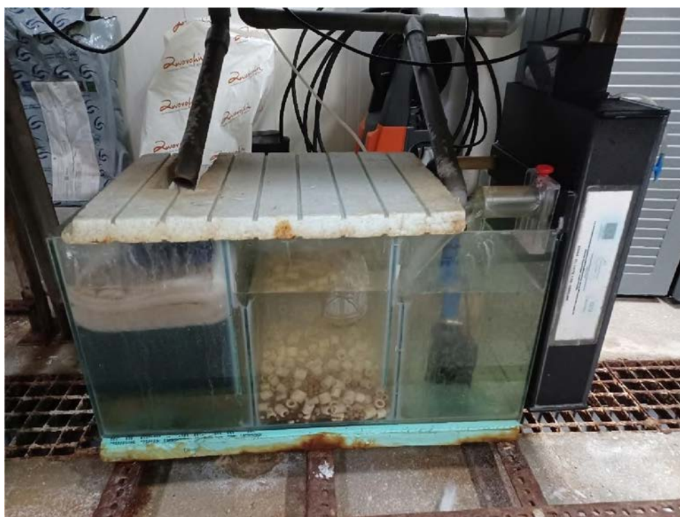
Εικόνα 2.9: Σύστημα μηχανικής – βιολογικής διήθησης του νερού. Πηγή: Προσωπικό αρχείο συγγραφέα.
