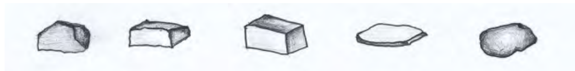
Εικόνα 2.3.: Τα είδη των λίθων ανάλογα με τον βαθμό κατεργασίας. Από αριστερά προς τα δεξιά: αργός, ημιξεστός, ξεστός, πλακοειδής, κροκάλη. Πηγή: ΕΘΝΙΚΟ ΜΕΤΣΟΒΙΟ ΠΟΛΥΤΕΧΝΕΙΟ, ΣΧΟΛΗ ΑΡΧΙΤΕΚΤΟΝΩΝ – ΜΗΧΑΝΙΚΩΝ
