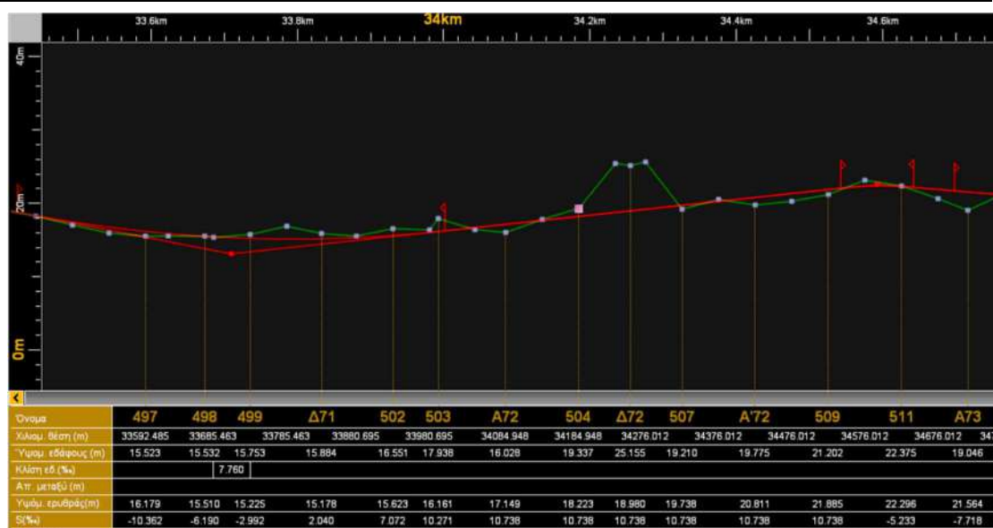
Εικόνα 4.18 Χ.Θ : 34+135 Συμβολή γραμμής με τμήμα οδού
