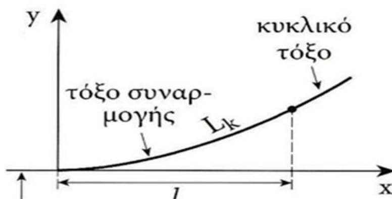
Σχήμα 2.3 Γεωμετρικά χαρακτηριστικά κυβικής καμπύλης συναρμογής μεταξύ ευθυγραμμίας και κυκλικής καμπύλης (Πυργίδης Χ., 2009)
