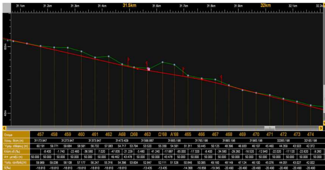
Εικόνα 4.17 X.Θ : 31+621 Συμβολή γραμμής με τμήμα οδού
