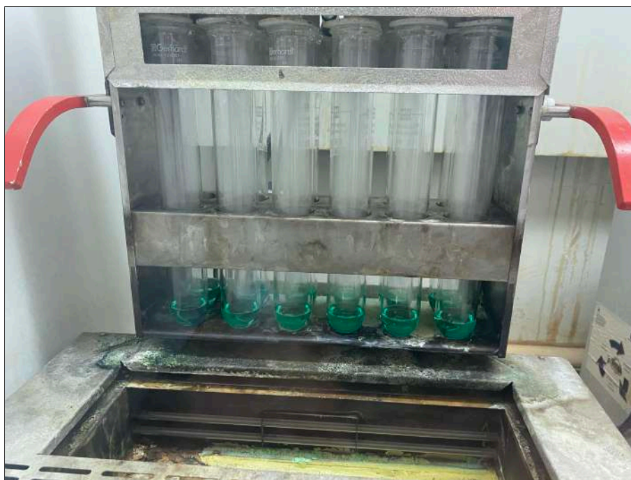
Σχήμα 6: Η συστοιχία των δειγμάτων αφότου ολοκληρώθηκε η πέψη, προκειμένου να αναλύθουν σύμφωνα με τη μέθοδο Kjeldahl . (Από προσωπικό αρχείο)
