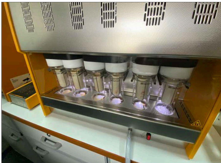
Σχήμα 8: Εργαστηριακό μηχάνημα εκχύλισης Soxhlet (Από προσωπικό αρχείο)
