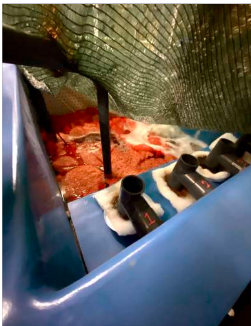
Σχήμα 5: Το σύστημα φίλτρανσης (μηχανικό & βιολογικό) του κλειστού συστήματος όπου διενεργήθηκε ο πειραματισμός της εκτροφής των ιχθύων. (Από προσωπικό αρχείο)
