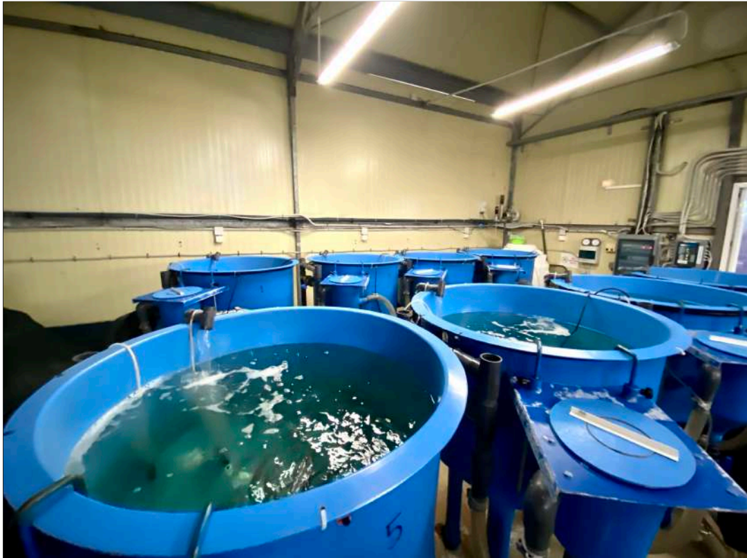
Σχήμα 4: Οι δεξαμενές και σωληνώσεις του κλειστού συστήματος επανακυκλοφορίας όπου διενεργήθηκε ο πειραματισμός της εκτροφής των ιχθύων. (Από προσωπικό αρχείο)
