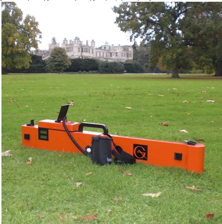
Εικόνα 13: Μετρητής Φαινόμενης Ηλεκτρικής Αγωγιμότητας EM38 – Mk. 2 (Geomatrix Earth Science Ltd.)
