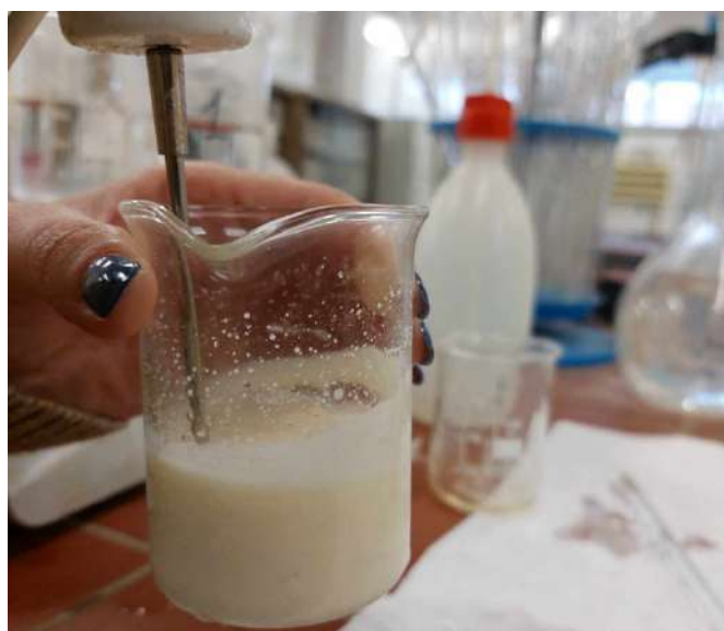
Εικόνα 37. Ανάδευση των δύο φάσεων και τελική παραγωγή προϊόντος
