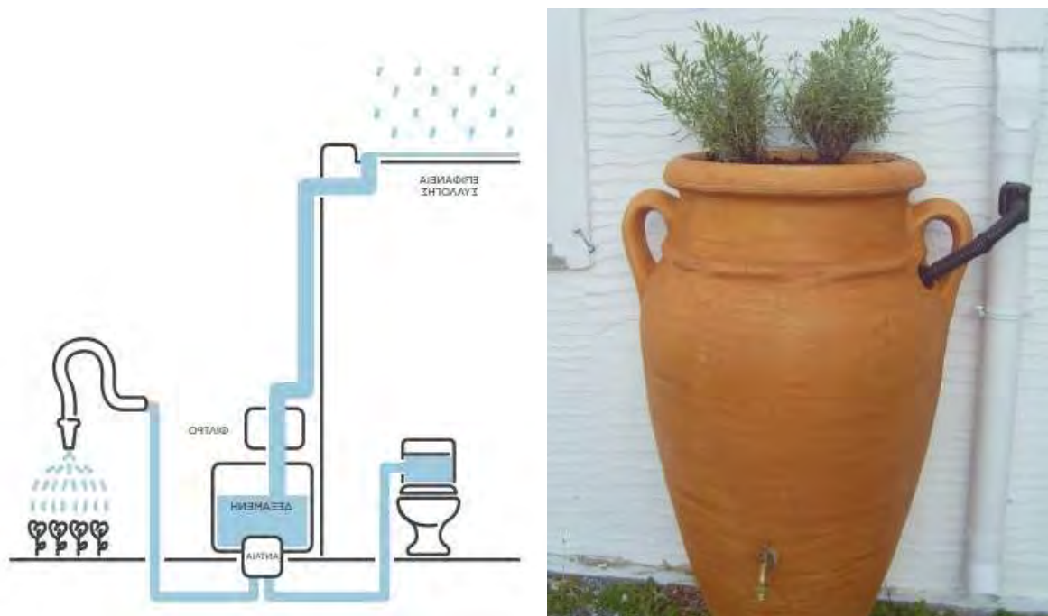
Εικόνα 58: Αριστερά: Απλή απεικόνιση μηχανισμού συλλογής ταμίευσης και χρήσης ομβρίων υδάτων. Δεξιά: Δοχείο συλλογής και ταμίευσης υδάτων σε νησί του αιγαίου Πελάγους, Ελλάς (πηγή: Global World Ppartnership -Med)
