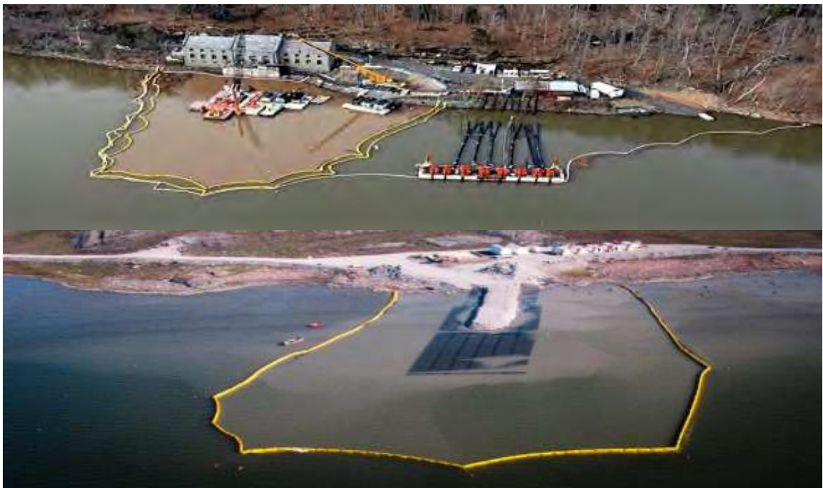
Εικόνα 116: Πλωτή κουρτίνα όπου με την τοποθέτηση της θα μπορούσε να είχε εμποδίσει τη διασπορά της ρύπανσης στις εκβολές των ρεμάτων της Μαγνησίας που καταλήγουν στον Παγασητικό κόλπο. (Πηγή: Διαδίκτυο)
