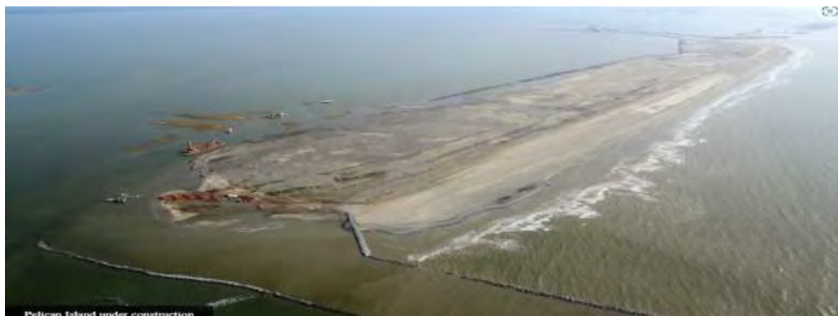
Εικόνα 137: Δημιουργία της Νησίδας Pelican. ενός από τα περισσότερα από τα νησιά που θα κατασκευαστούν, είμαστε σε θέση να αναδημιουργήσουμε ολόκληρο τον βιότοπο από τις παραλίες του Κόλπου του Μεξικού. Η άμμος και η λάσπη συλλέγονται από υπεράκτιες ή ανανεώσιμες πηγές στον ποταμό Μισισσιπή χρησιμοποιώντας μια υδραυλική βυθοκόρηση. Η άμμος και η λάσπη αντλούνται δεκάδες μίλια μακριά για να διαμορφωθούν σε νέο βιότοπο όπου κάποτε υπήρχαν νησιά φραγμού. (Πηγή: https://www.habitat.noaa.gov )
