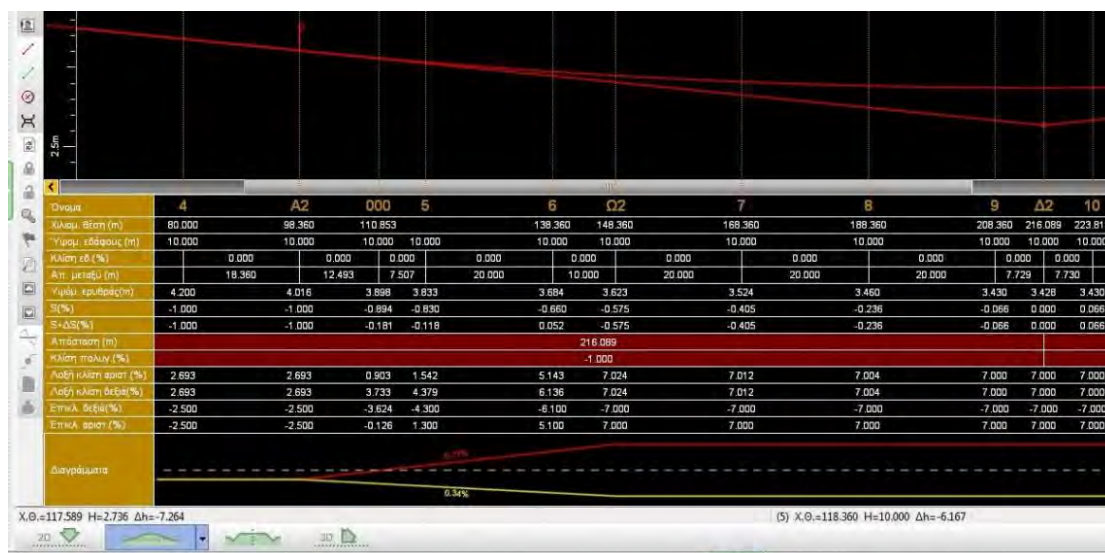
Σχήμα 4.5 Μέρος ερυθράς με διάγραμμα κλίσεων και σημειογραφία σχετικών μεγεθών ανά διατομή (Anadelta Tesser)
