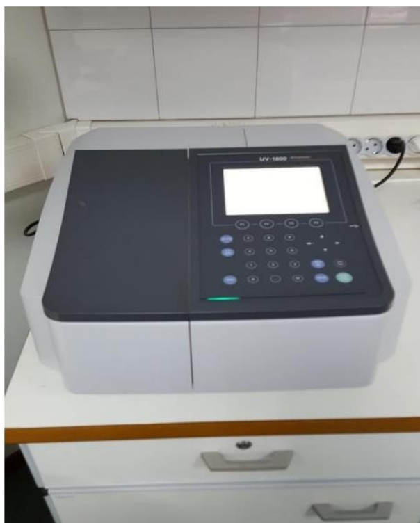
Εικόνα 6: Φασματοφωτόμετρο (SHIMADZU UV-1800) για την ανάλυση των θρεπτικών αλάτων του νερού στους 3 σταθμούς δειγματοληψίας και σε 3 διαφορετικά βάθη.
