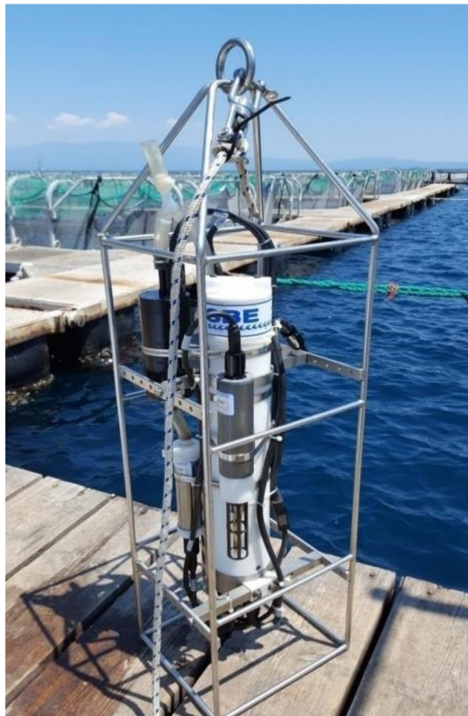
Εικόνα 5: Ο συνεχής καταγραφέας CTD (SEABIRD-19plus), που χρησιμοποιήθηκε για τη μέτρηση των φυσικοχημικών και βιολογικών παραμέτρων του νερού στα 3 σημεία δειγματοληψίας.
