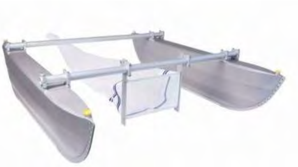
Εικόνα 9. Σύστημα αλίευσης μικροπλαστικών ρύπων Neuston catamaran (manta-neuston) (Πηγή: Thompson, 2015).
