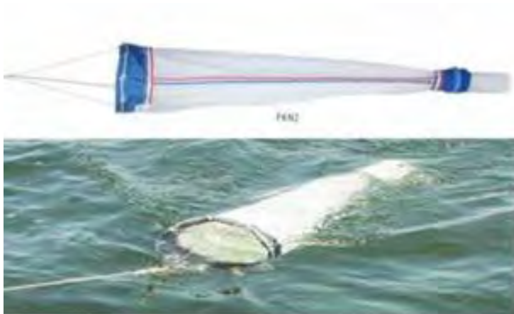
Εικόνα 10. Δίχτυα πλαγκτού με δυνατότητα οριζόντιας και κατακόρυφης σύρσης (Πηγή: Thompson).
