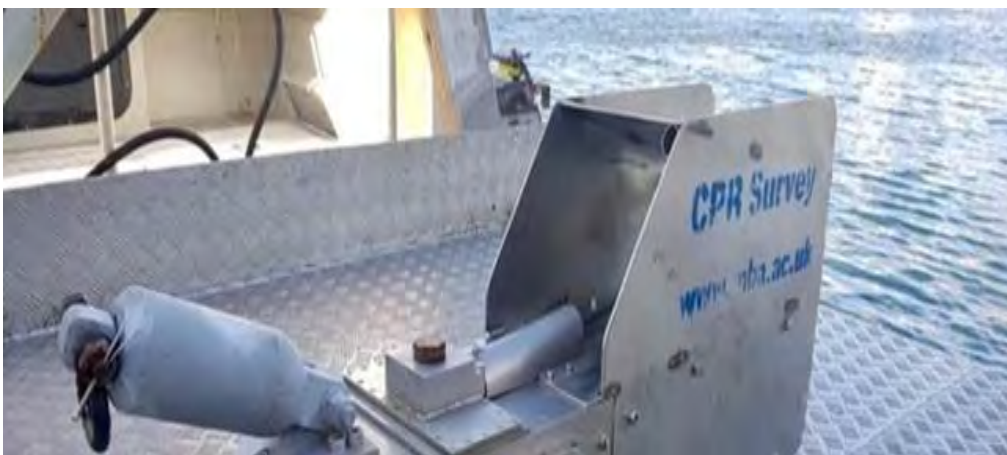
Εικόνα 12. Συλλέκτης και καταγραφέας πλαγκτού CPR (Πηγή: Science facts).
