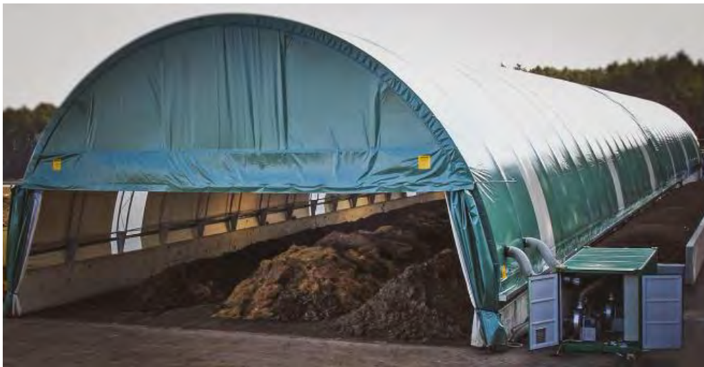
Εικόνα 3.6. Κομποστοποίηση σειραδίων κλειστού τύπου (Πηγή: Compost Systems GmbH)
