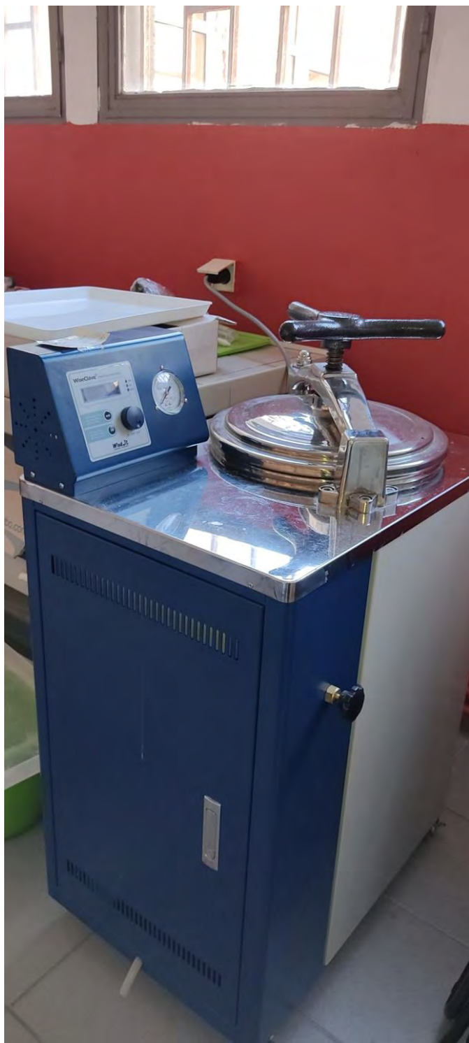
Εικόνα 9. Αυτόκαυστος κλίβανος για αποστείρωση θρεπτικών και θανάτωση αποικιών.
