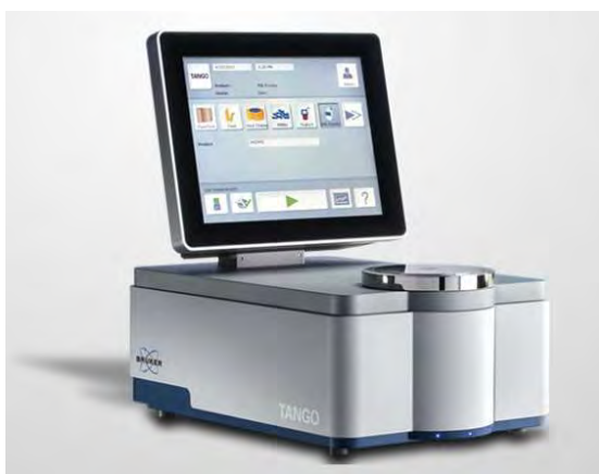
Εικόνα 2.2. Το σύστημα φασματοσκοπίας εγγύς υπερύθρου (Tango FT-NIR) της εταιρείας Bruker που χρησιμοποιήθηκε για την ανίχνευση των μυκοτοξινών.
