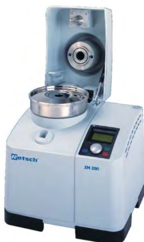
Εικόνα 2.1. Ο μύλος άλεσης (ZM 200 Ultra Centrifugal Mill) της εταιρείας Retsch με διάμετρο κοπής 1mm που χρησιμοποιήθηκε για την επεξεργασία των δειγμάτων
