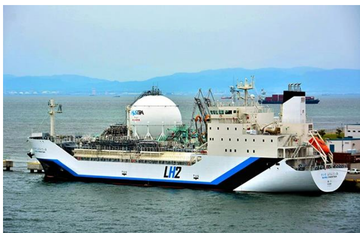
Σχήμα 5.3. Δεξαμενόπλοιο μεταφοράς υδρογόνου[187].
