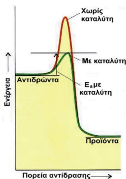
Σχήμα 2.4. Πορείες πραγματοποίησης της αντίδρασης με και χωρίς προσθήκη καταλύτη [15].
