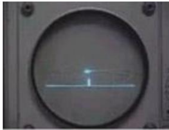
Εικόνα 1: το Tennis for two στην «οθόνη» δεξιά και αριστερά ο εξοπλισμός που χρειαζόταν (Overmars, 2012).
