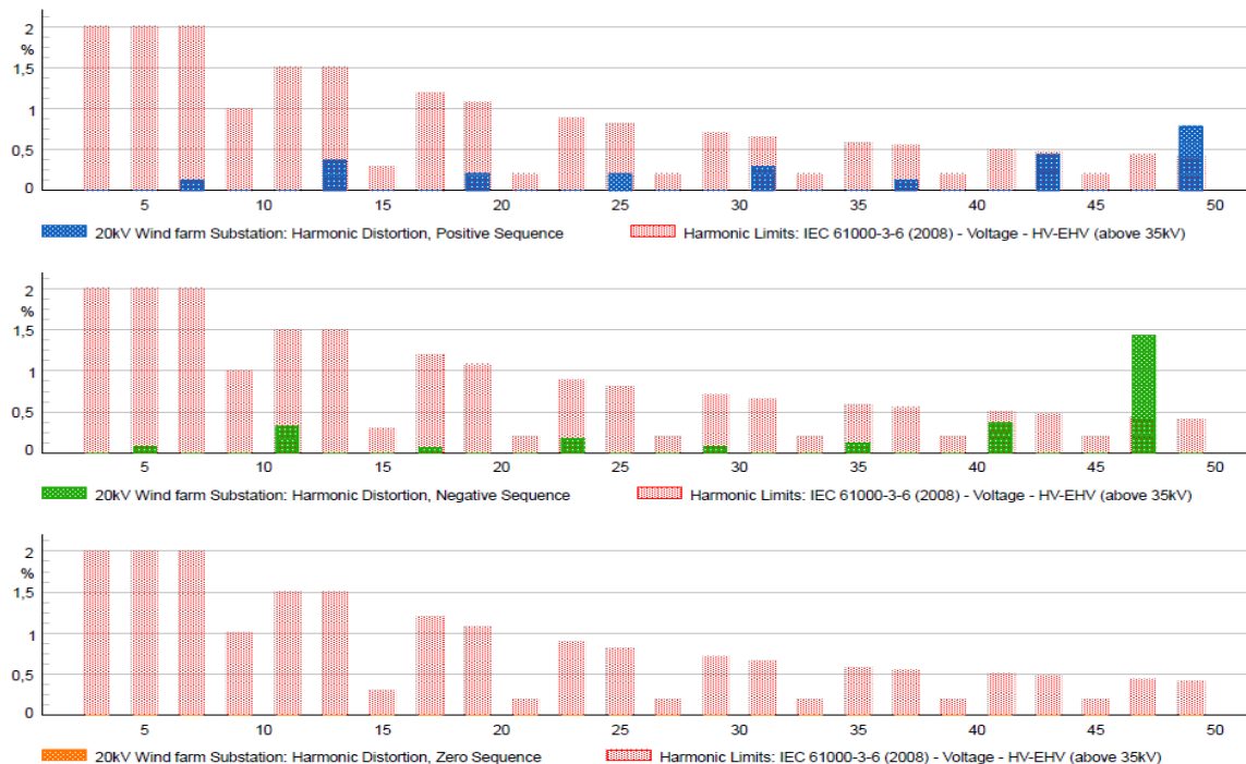
Διάγραμμα 5. Ισορροπημένη συνολική αρμονική παραμόρφωση στο ζυγό υποσταθμού της βιομηχανίας χωρίς φίλτρο.
