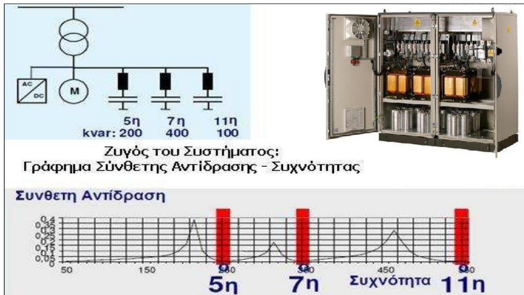
Εικόνα 14. Παθητικό συντονισμένο φίλτρο - Αρχή λειτουργίας. [19]
