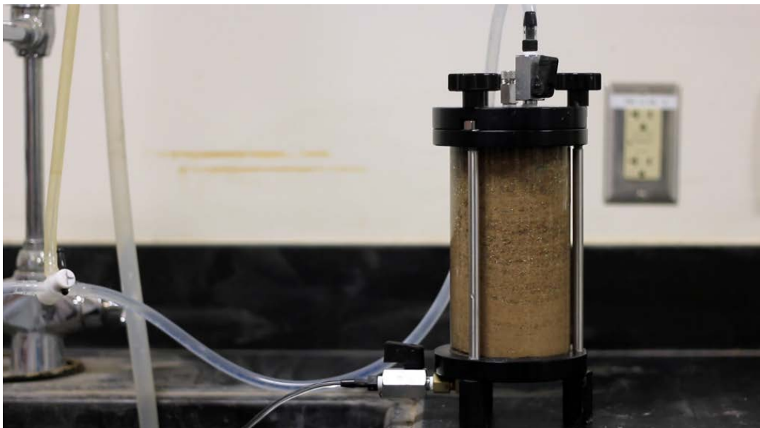
Εικόνα 2.8 Το εδαφικό δείγμα έχει κορεστεί , Πηγή: (Hossain, et al., 2021)
