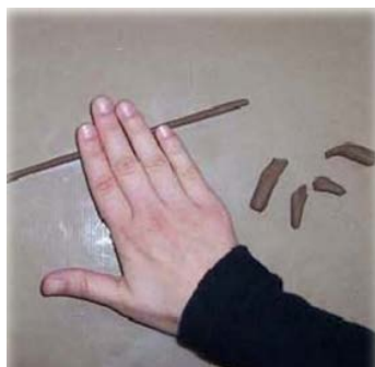
Εικόνα 3.8 Θρυμματισμός εδαφικού δείγματος. Πηγή: (Χριστοδούλου, 2021).
