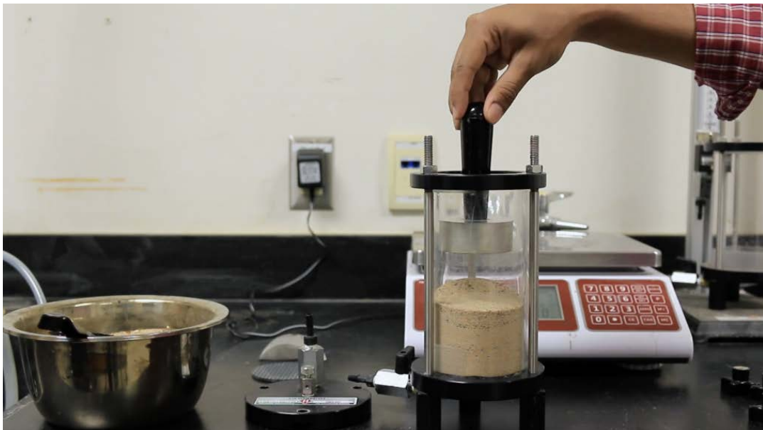
Εικόνα 2.5 . Συμπίεση του δείγματος εδάφους στο καλούπι διαπερατότητας, Πηγή: (Hossain, et al., 2021)
