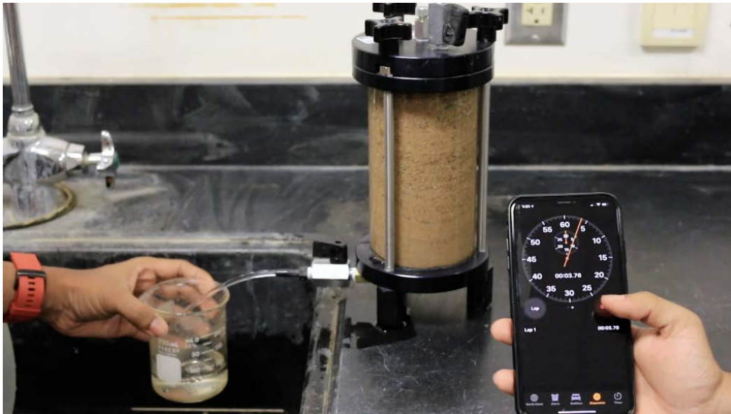
Εικόνα 2.9 Μέτρηση του όγκου του νερού σε σχέση με το χρόνο, Πηγή: (Hossain, et al., 2021)
