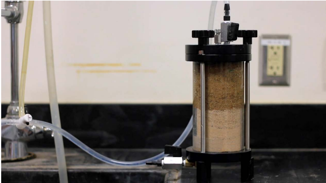
Εικόνα 2.7 Το εδαφικό δείγμα αρχίζει να γίνεται κορεσμένο , Πηγή: (Hossain, et al., 2021)
