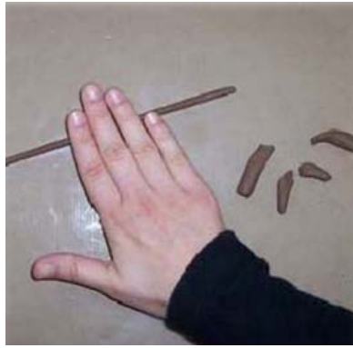
Εικόνα 1.9 Προσδιορισμός ορίου πλαστιμότητας, Πηγή: (Χριστοδούλου, 2021)
