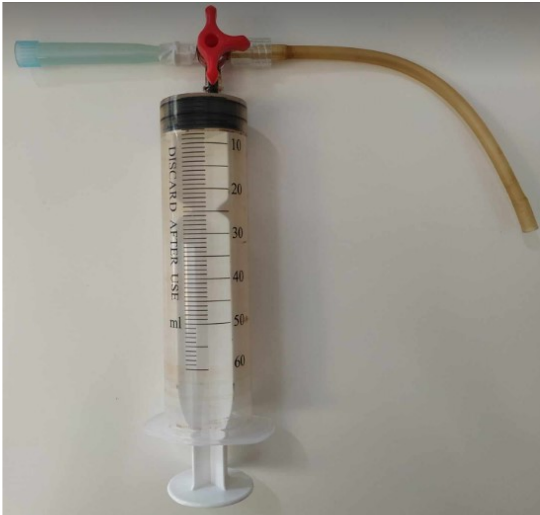
Εικόνα 1. Η αυτοσχέδια συσκευή για την εισαγωγή καπνού τσιγάρου.
