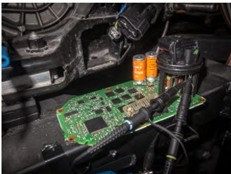
Εικόνα 4 Παράδειγμα μιας ECU για το σύστημα EPS [1]
