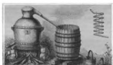
Άμβυκας απόσταξης στέμφυλων τύπου με βραχίονα
