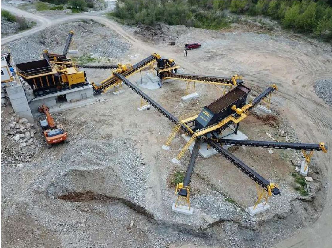
Εικόνα 18: Εργοστάσιο σύνθλιψης και παραγωγής (machineryline.info 2023)
