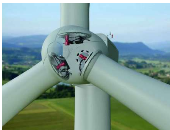
ΕΙΚΟΝΑ 13: Pitch ανεμογεννήτριας (industry.com 2012)
