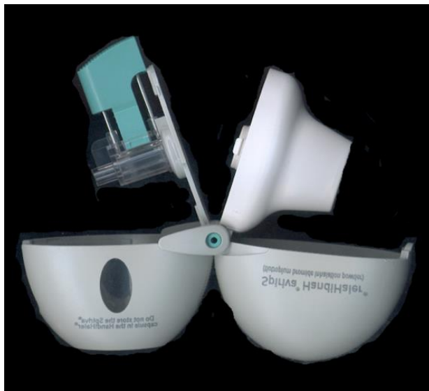
Εικόνα 8: Εσωτερική δομή της DPI συσκευής «Handihaler», https://commons.wikimedia.org/wiki/File:%22Spiriva_HandiHaler%22=brand_dry_powder_inhaler_%28open%29.png
