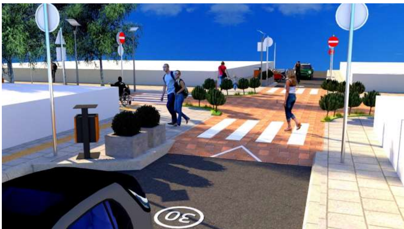
ΦΩΤΟΡΕΑΛΙΣΤΙΚΗ ΑΠΕΙΚΟΝΙΣΗ 8.8: Διασταύρωση τύπου I Προτεινόμενη Ενδεικτική Διαμόρφωση ως Υπερυψωμένη Διασταύρωση Αποχώρηση από τη δευτερεύουσα οδό 2 (σημείο συμβολής) – Ιδία επεξεργασία
