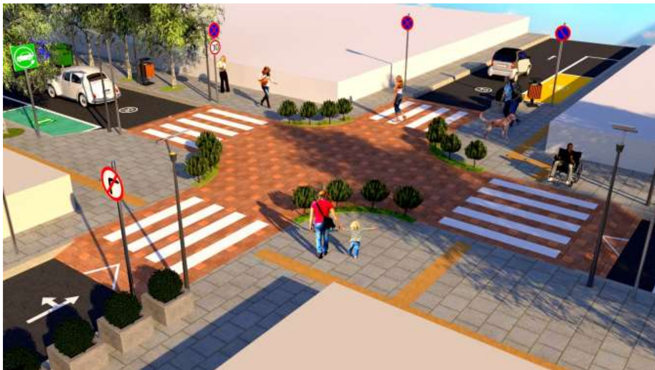
ΦΩΤΟΡΕΑΛΙΣΤΙΚΗ ΑΠΕΙΚΟΝΙΣΗ 8.9: Διασταύρωση τύπου Ι Προτεινόμενη Ενδεικτική Διαμόρφωση ως Υπερυψωμένη Διασταύρωση AERIAL VIEW 1 – Ιδία επεξεργασία
