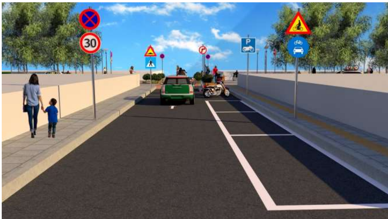
ΦΩΤΟΡΕΑΛΙΣΤΙΚΗ ΑΠΕΙΚΟΝΙΣΗ 8.3: Διασταύρωση τύπου I Προτεινόμενη Ενδεικτική Διαμόρφωση ως Υπερυψωμένη Διασταύρωση Προσέγγιση από τη δευτερεύουσα οδό 2 (γενική άποψη) – Ιδία επεξεργασία
