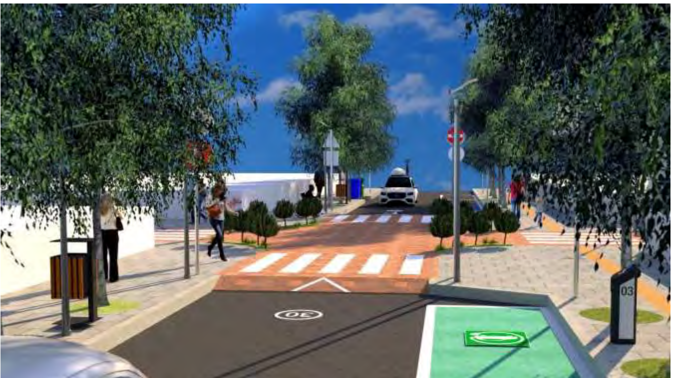
ΦΩΤΟΡΕΑΛΙΣΤΙΚΗ ΑΠΕΙΚΟΝΙΣΗ 8.6: Διασταύρωση τύπου Ι Προτεινόμενη Ενδεικτική Διαμόρφωση ως Υπερυψωμένη Διασταύρωση Αποχώρηση από τη δευτερεύουσα οδό 1 (σημείο συμβολής) – Ιδία επεξεργασία
