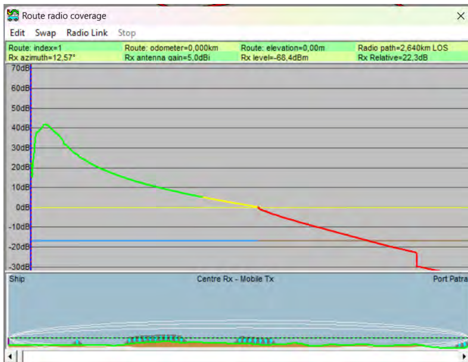
Εικόνα 15. . Παράθυρο αποτελέσματος προσομοίωσης για Uplink από Πάτρα με επιλογή στο όριο προς κακή απόδοση σήματος
