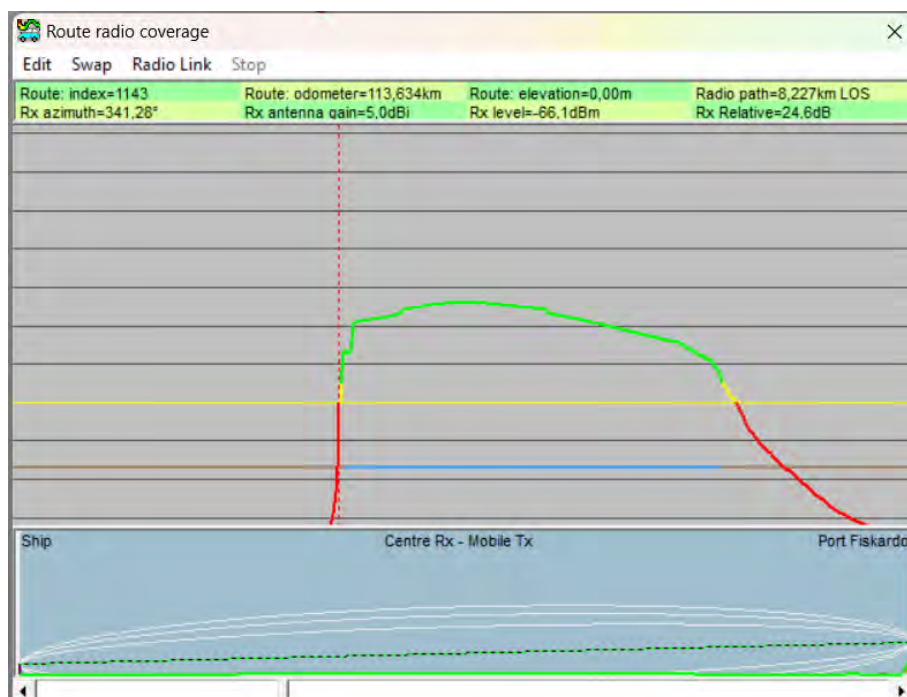
Εικόνα 29. Παράθυρο αποτελέσματος προσομοίωσης για Uplink από Φισκάρδο με επιλογή στο όριο προς κακή απόδοση σήματος
