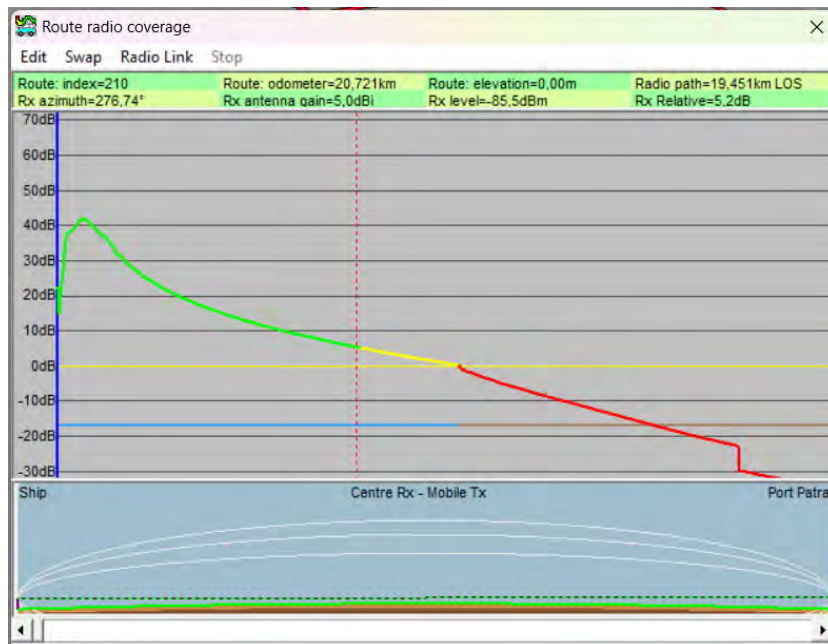
Εικόνα 16. Παράθυρο αποτελέσματος προσομοίωσης για Uplink από Πάτρα με επιλογή στο όριο προς μέτρια απόδοση σήματος
