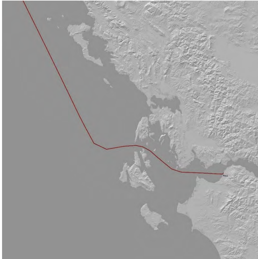
Εικόνα 44. Χάρτης από το RADIO MOBILE TOOL με εμφάνιση πεδίου διαδρομής με σήμα από την κεραία στην Πρέβεζα σε Downlink
