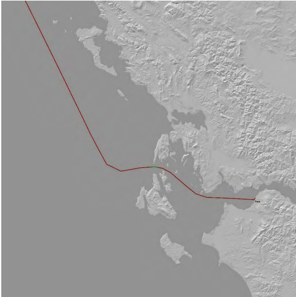
Εικόνα 42. Χάρτης από το RADIO MOBILE TOOL με εμφάνιση πεδίου διαδρομής με σήμα από την κεραία στο Βασιλική σε Uplink
