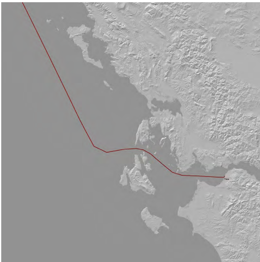
Εικόνα 19. Χάρτης από το RADIO MOBILE TOOL με εμφάνιση πεδίου διαδρομής με σήμα από την κεραία στο Βαθύ σε Downlink
