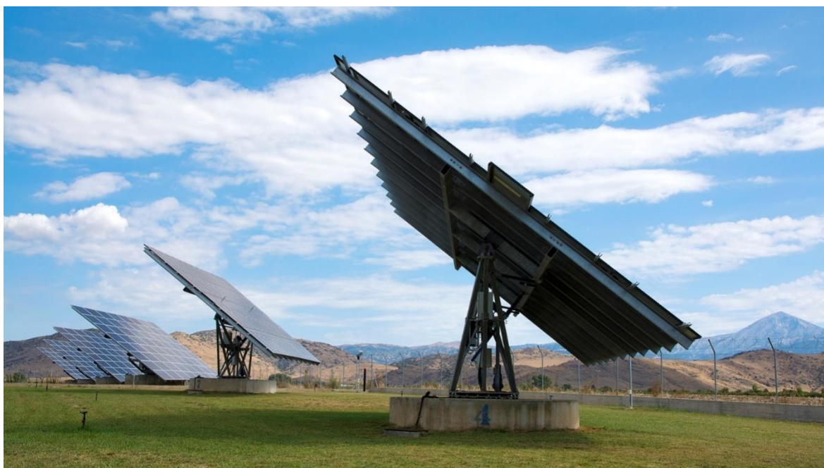
Εικόνα 6.3: Φωτοβολταϊκά πλαίσια με ιχνηλάτη διπλού άξονα
