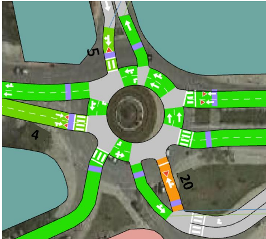
Εικόνα 5.12: Stop time κυκλικού κόμβου Τελωνείου
