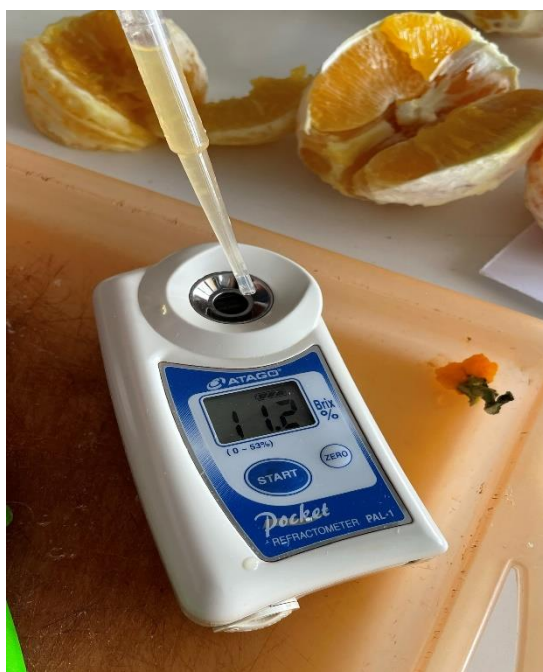
Εικόνα 1. μέτρηση της περιεκτικότητας σε διαλυτά στερεά συστατικά του χυμού (ΔΣΣ %), με ηλεκτρονικό διαθλασίμετρο
