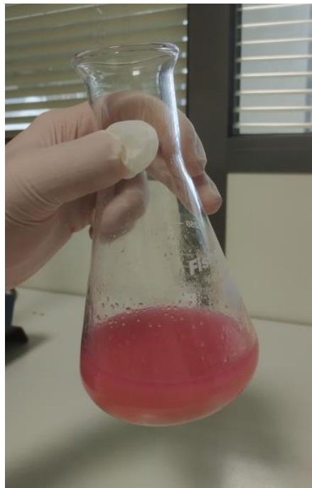
Εικόνα 8: Μέτρηση οξύτητας με τη μέθοδο τιτλοδότησης. Πηγή: Προσωπικό αρχείο.
