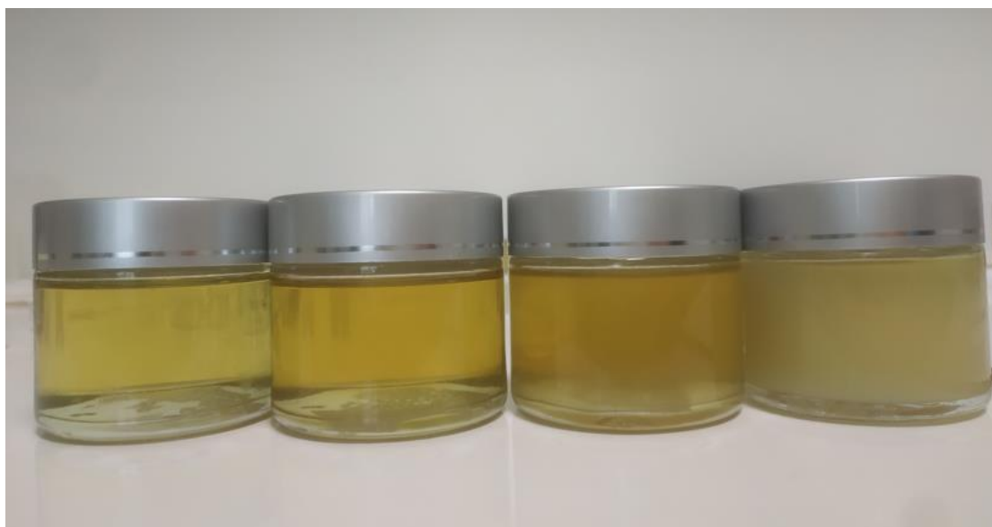
Εικόνα 12: Νωπό Πυρηνέλαιο 1 ος μήνας σε διαφορετικές συνθήκες (φως, σκοτάδι, συντήρηση, κατάψυξη) από αριστερά προς δεξιά. Το τελευταίο δείγμα στη φωτογραφία είναι στη θερμοκρασία των -20°C. Οι μετρήσεις γίνανε σε όλα τα δείγματα σε Θ°C περιβάλλοντος.
