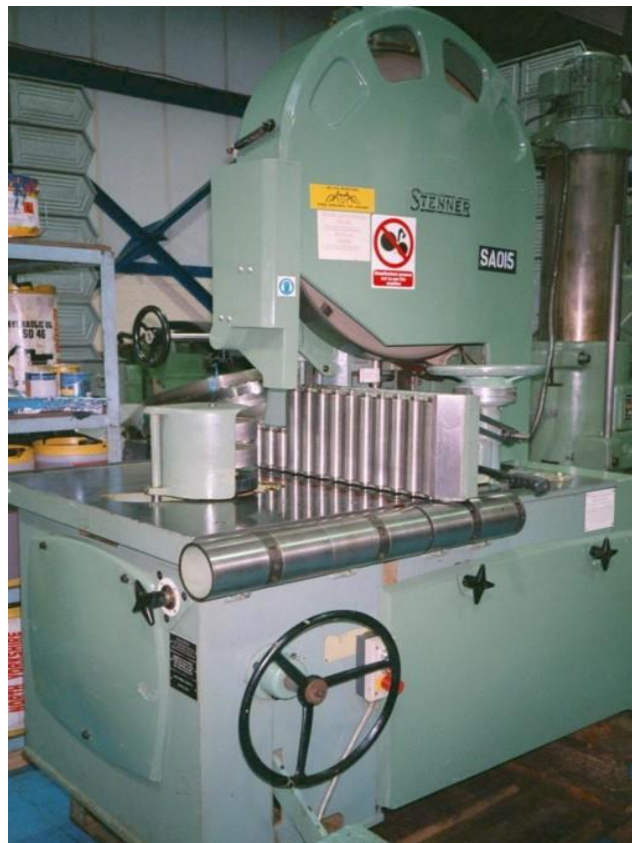
Εικόνα 7: Μηχάνημα (ταινιοπρίονας) επανάπρισης, της εταιρείας Stenner.
