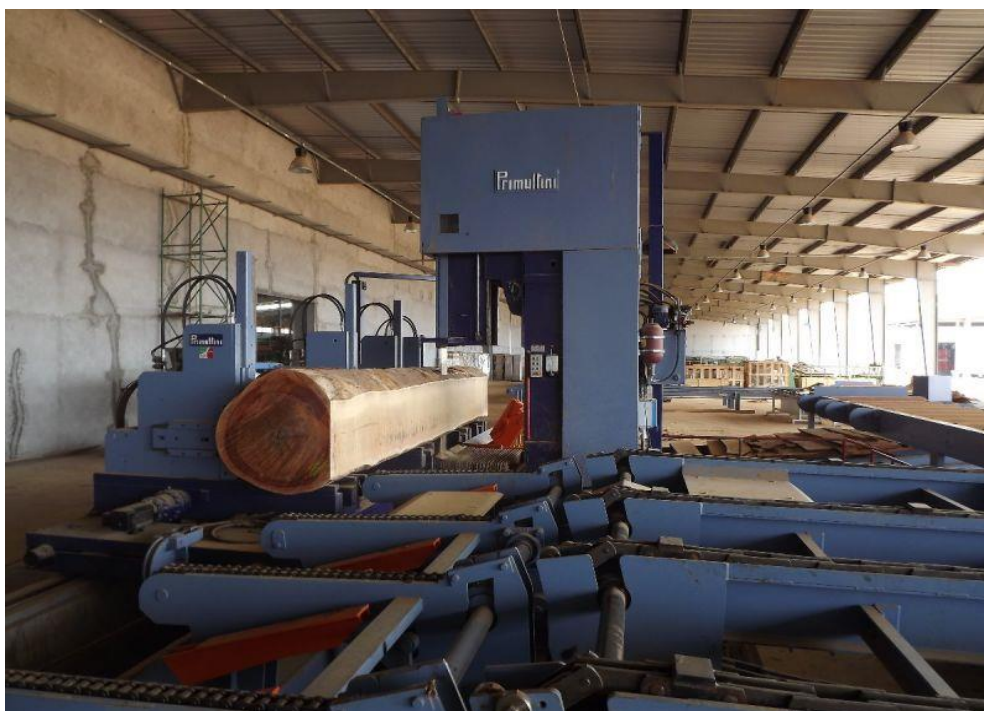
Εικόνα 2: Κορμοκόπτης - ταινιοπρίονο της ιταλικής εταιρείας Primultini αποτελούμενος από ταινιοπρίονα (πριονοκορδέλα) με βαγόνι μεταφοράς και πλαϊνή μεταφορά πλάκας.
