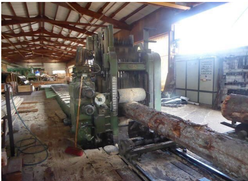
Εικόνα 1: Πολυπρίονο γερμανικής προέλευσης σε λειτουργία.
