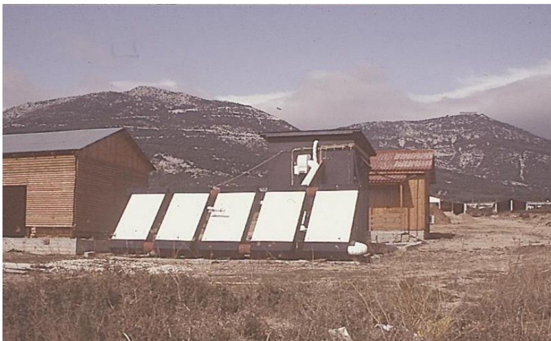
Εικόνα 19: Ηλιακό ξηραντήριο κατασκευασμένο από το Ινστιτούτο Δασικών Ερευνών Αθηνών.
