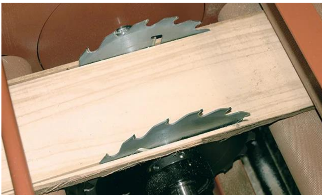
Εικόνα 5: Παράλληλη αφαίρεση εξακριδίων ξυλείας, σε παρυφωτή με 2 δίσκους
