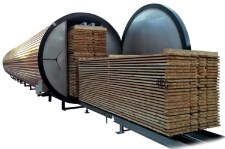
Εικόνα 17: Ξηραντήριο με θάλαμο κενού και βαγόνι φόρτωσης
