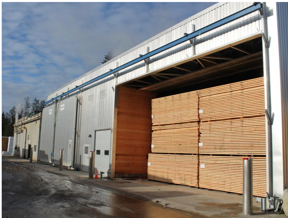
Εικόνα 11: Θάλαμοι ξήρανσης της εταιρείας Mühlböck με παλέτες ξυλείας
