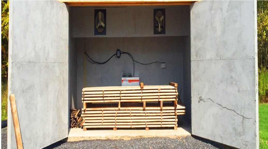
Εικόνα 18: Θάλαμος ξήρανσης με αφύγρανση.
