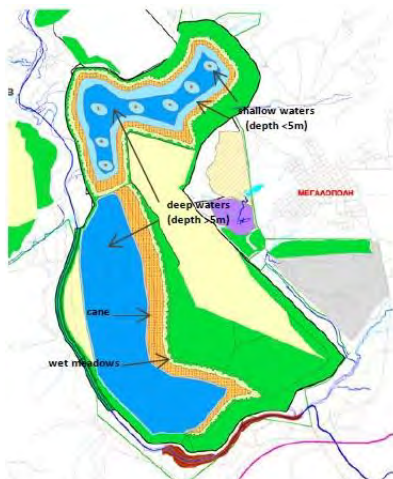
Εικόνα 40: Σχεδιασμένοι υγρότοποι σε ορυχεία Χωρεμίου και Μαραθούσας, σύμφωνα με Μελέτη ΜΠΕ της ΔΕΗ Πηγή: PPC SA (2016). Environmental Impact Assessment Study for PPC Megalopolis Mines
