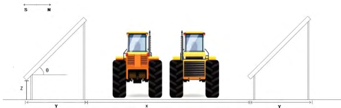
Εικόνα 51: Επίγειες φωτοβολταϊκές μονάδες με τον απαραίτητο χώρο για τον γεωργικό εξοπλισμό Πηγή: The potential of agrivoltaics systems, Renewable and Sustainable Energy Reviews
