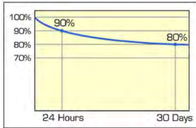
Εικόνα 58 : Αυτοεκφόρτιση συσσωρευτή που έχει ως βάση το νικέλιο σε συνάρτηση με το χρόνο [26].
