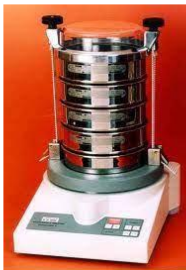
Σχήμα 2.3 Τα κόσκινα τοποθετημένα το ένα πάνω στο άλλο, πάνω στην δονητική τράπεζα (Τομάζου κ.α., 2012)
