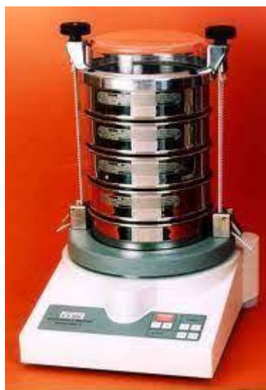
Σχήμα 2.3 Τα κόσκινα τοποθετημένα το ένα πάνω στο άλλο, πάνω στην δονητική τράπεζα (Τομάζου κ.α., 2012)
