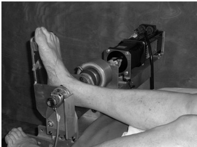
Εικόνα 3. Αυτοσχέδιος μηχανισμός με ποτενσιόμετρο (Westlake et al., 2007).
