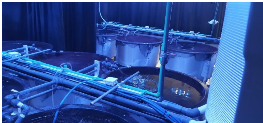
Εικόνα 3. Σύστημα οξυγόνωσης πειραματικών δεξαμενών 500lt
