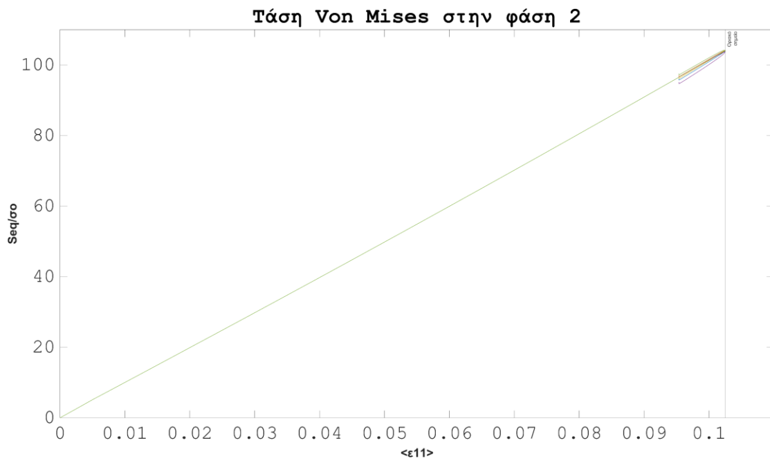
Διάγραμμα 12: Τάση Von Mises σε 10 στοιχεία του πλέγματος που ανήκουν: (α)φάση 1 (β)φάση 2, για καθαρή διάτμηση, E^{(2)} = 10E^{(1)} και \theta = 5^\circ .
