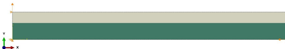
Εικόνα 2: Μοντέλο με επίπεδες στρώσεις που υφίσταται καθαρή διάτμηση. Η πράσινη στρώση αντιστοιχεί στην φάση 2.
