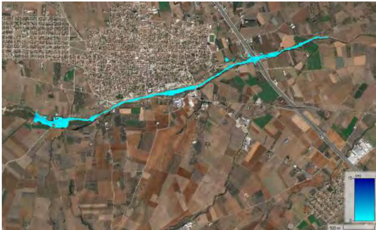
Σχήμα 52 Χάρτης πλημμυρικής κατάκλισης T=50 ευμενής συνθήκες
