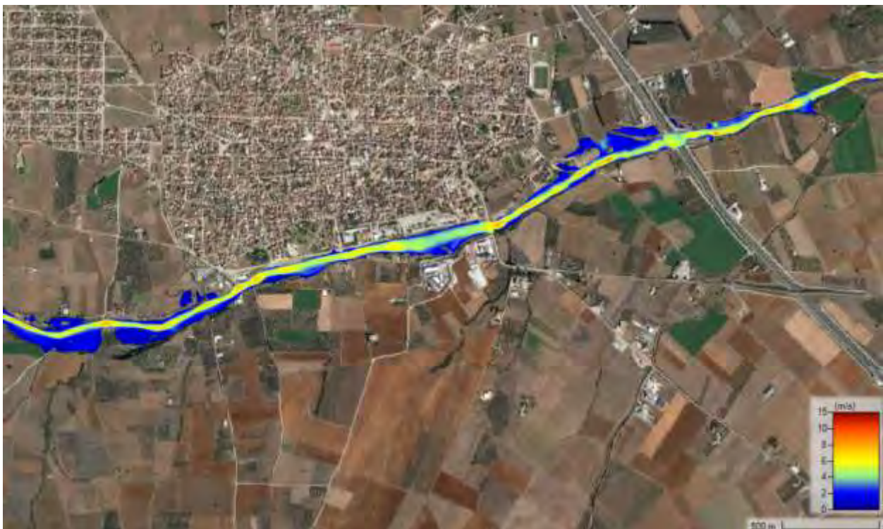
Σχήμα 46 Χάρτης ταχυτήτων ροής T=100 μέσες συνθήκες
