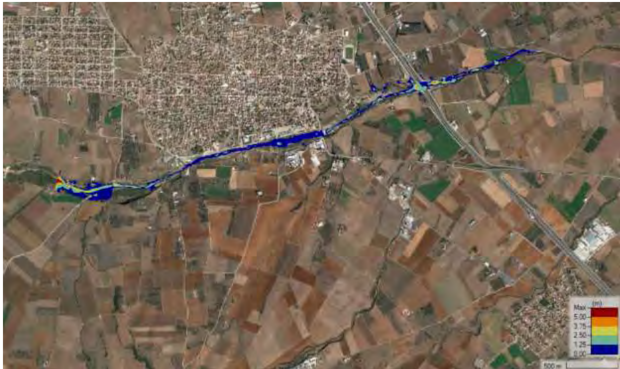
Σχήμα 56 Χάρτης βαθών πλημμύρας T=50 ευμενής συνθήκες
