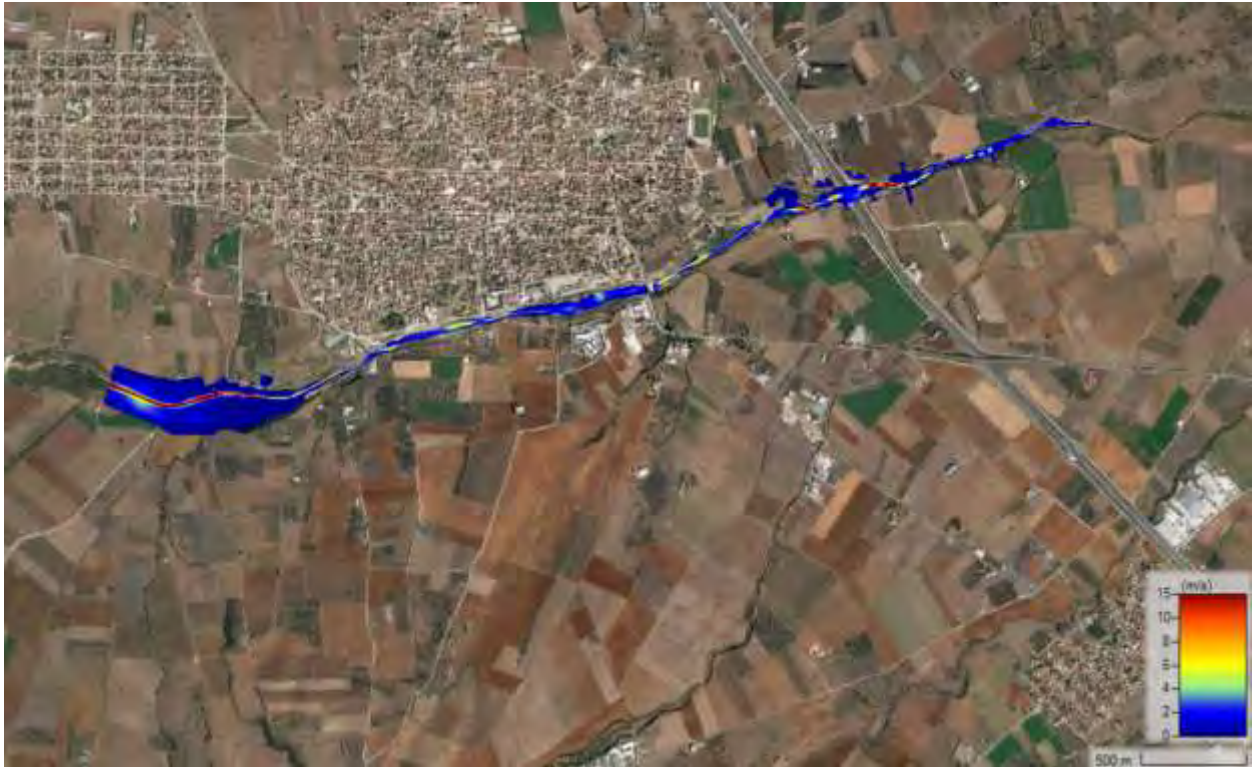
Σχήμα 61 Χάρτης ταχυτήτων ροής T=50 μέρες συνθήκες
