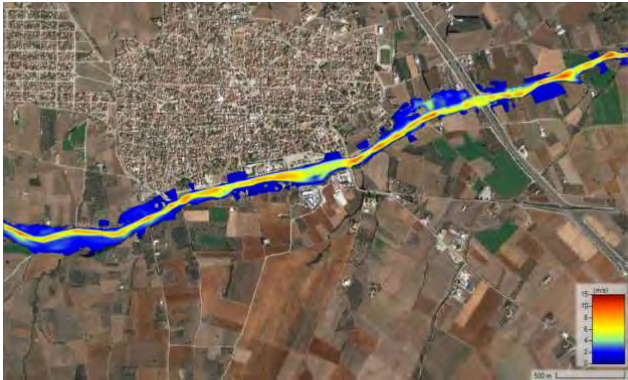
Σχήμα 47 Χάρτης ταχυτήτων ροής T=1000 μέσες συνθήκες
