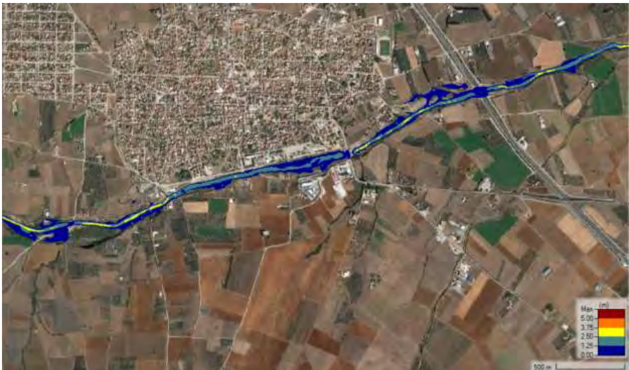
Σχήμα 85 Χάρτης βάθους ροής για T=1000 ευμενής συνθήκες
