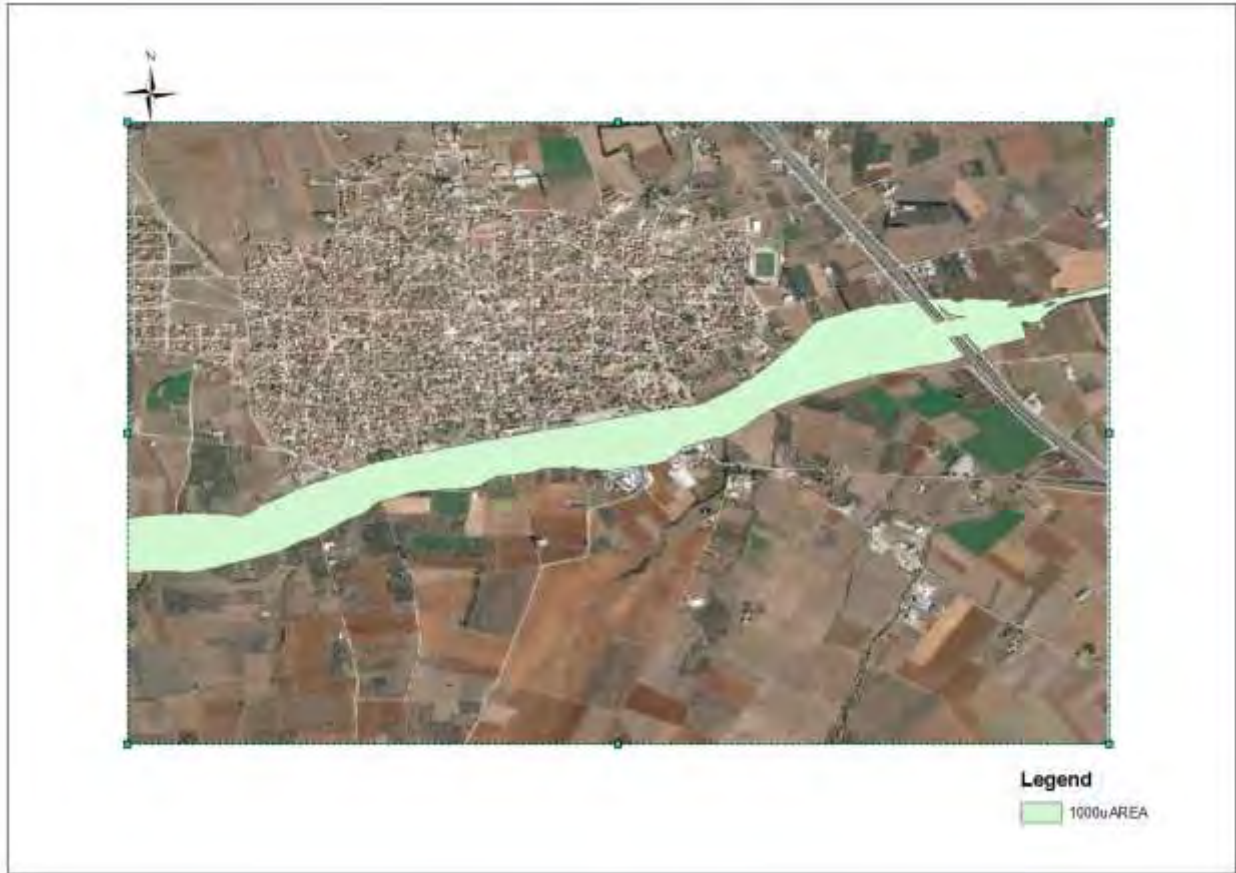
Σχήμα 111 Χάρτης συνολικής έκτασης πλημμύρας T=1000 δυσμενής συνθήκες
