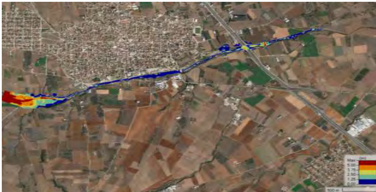
Σχήμα 57 Χάρτης βαθών πλημμύρας T=50 μέσες συνθήκες
