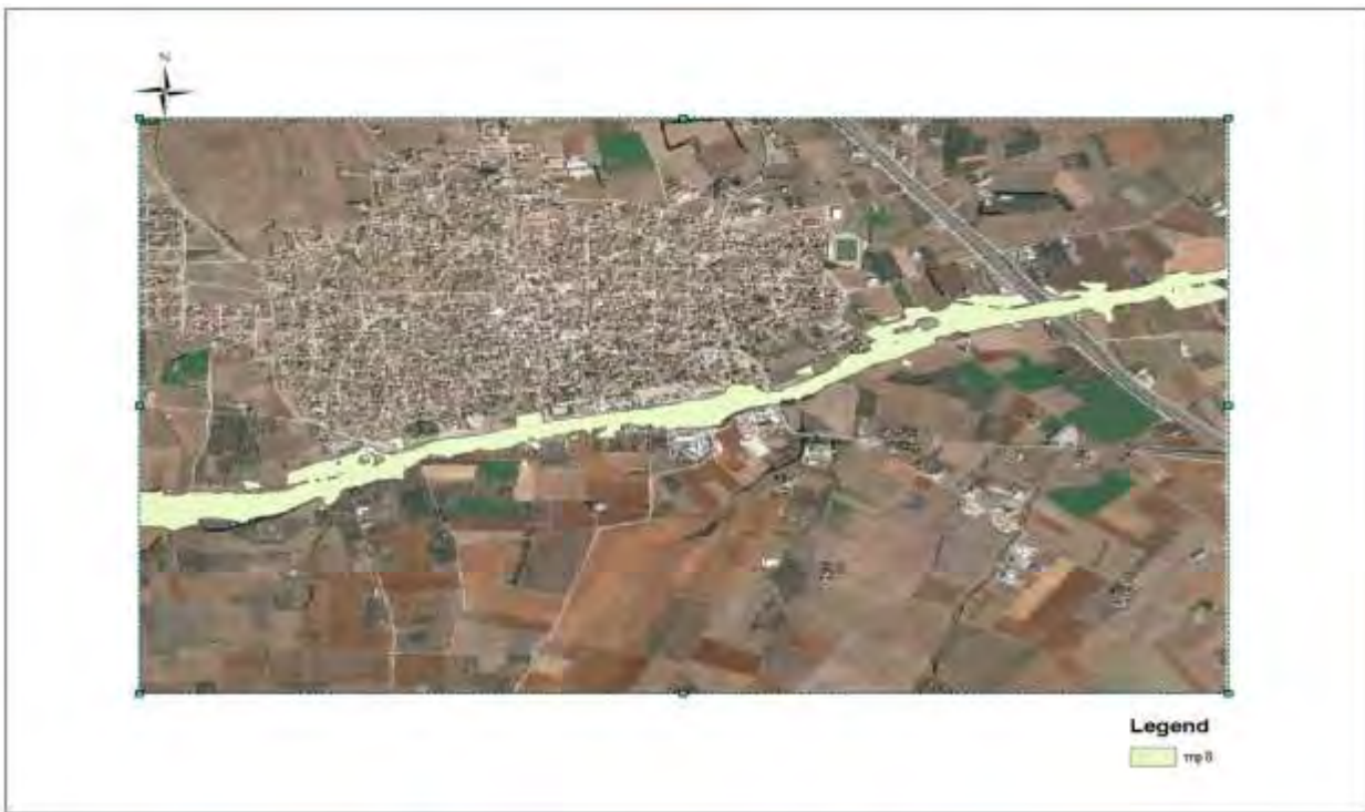
Σχήμα 51 Χάρτης έκτασης πλημμύρας T=1000 μέσες συνθήκες
