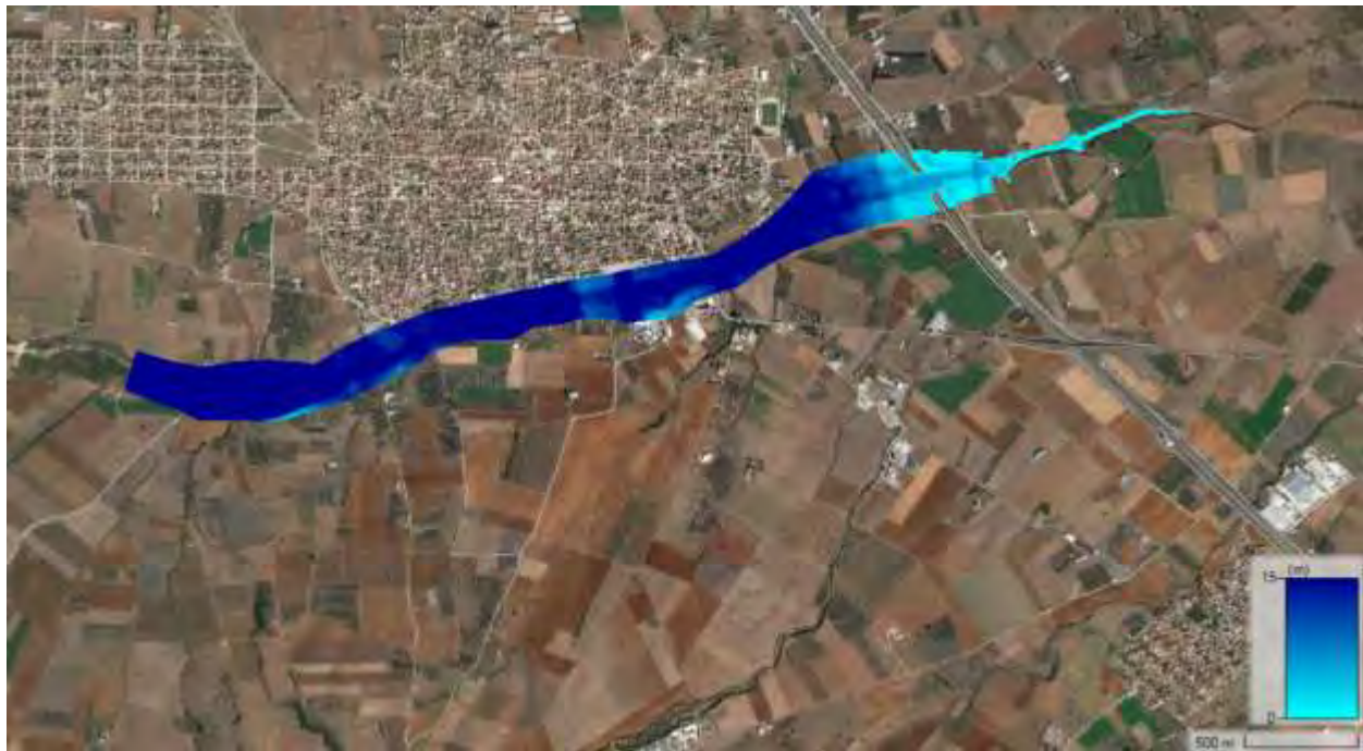
Σχήμα 108 Χάρτης κατακλισμένης περιοχής για T=1000 δυσμενής συνθήκες
