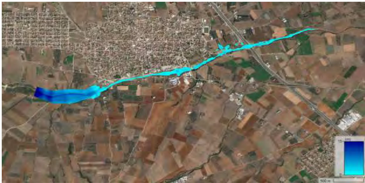
Σχήμα 100 Χάρτης κατακλισμένης περιοχής για T=100 δυσμενής συνθήκες
