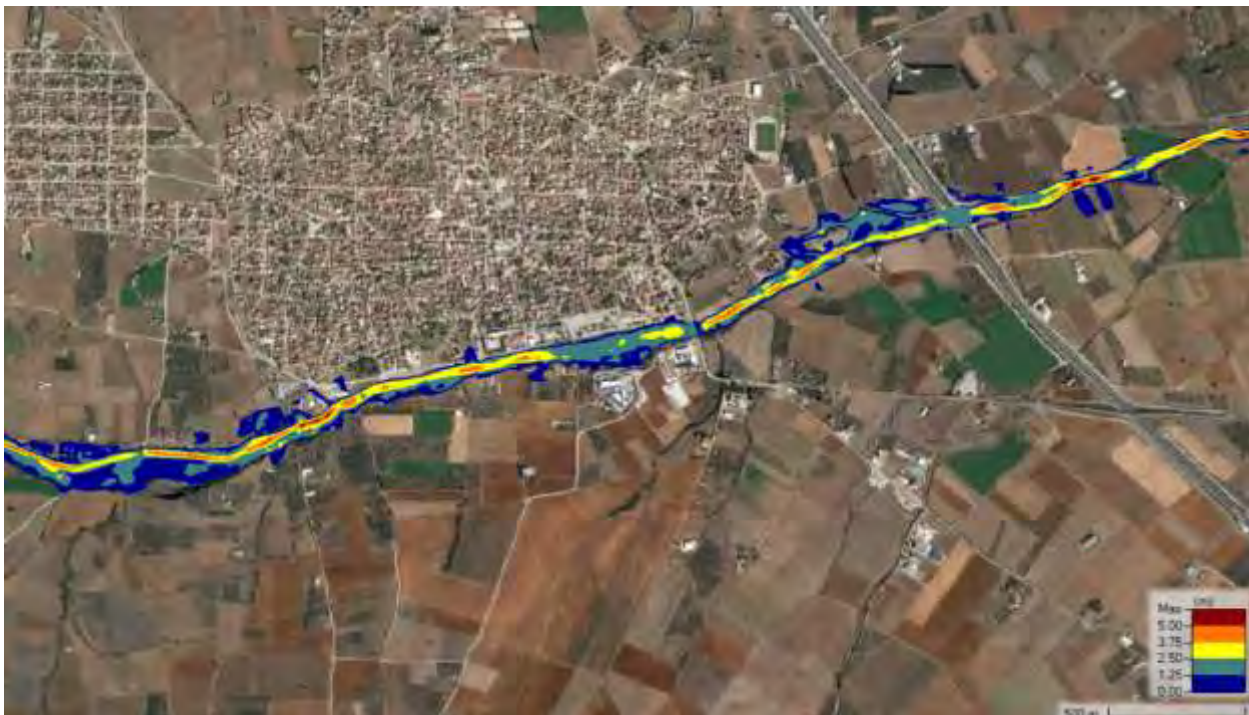
Σχήμα 73 Χάρτης βάθους ροής για T=50 δυσμενής συνθήκες
