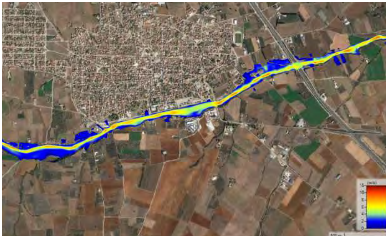
Σχήμα 74 Χάρτης ταχυτήτων ροής T=50 δυσμενής συνθήκες
