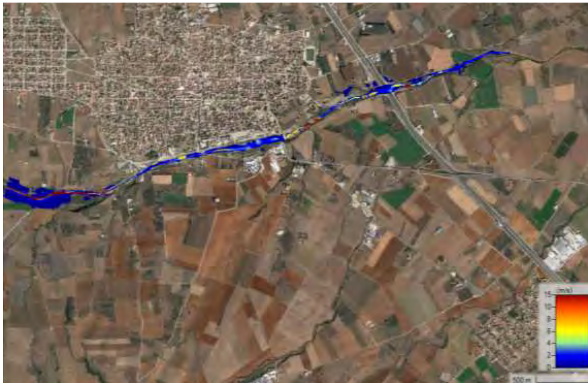
Σχήμα 98 Χάρτης ταχυτήτων ροής για T=100 ευμενής συνθήκες
