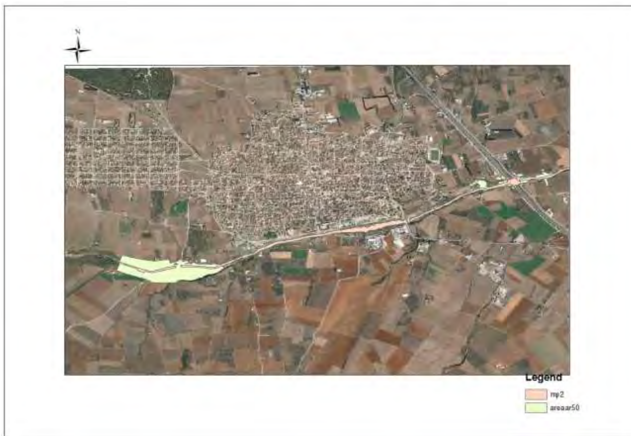
Σχήμα 70 Σύγκριση εμβαδόν κατάκλισης μόνιμης-μη μόνιμης ροής, T=50 μέσες συνθήκες
