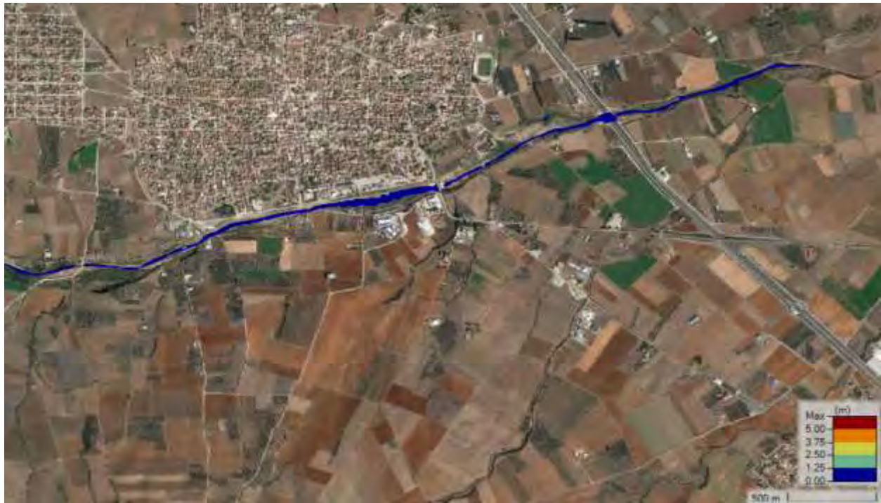
Σχήμα 40 Χάρτης βαθών ροής T=50 ευμενής συνθήκες
