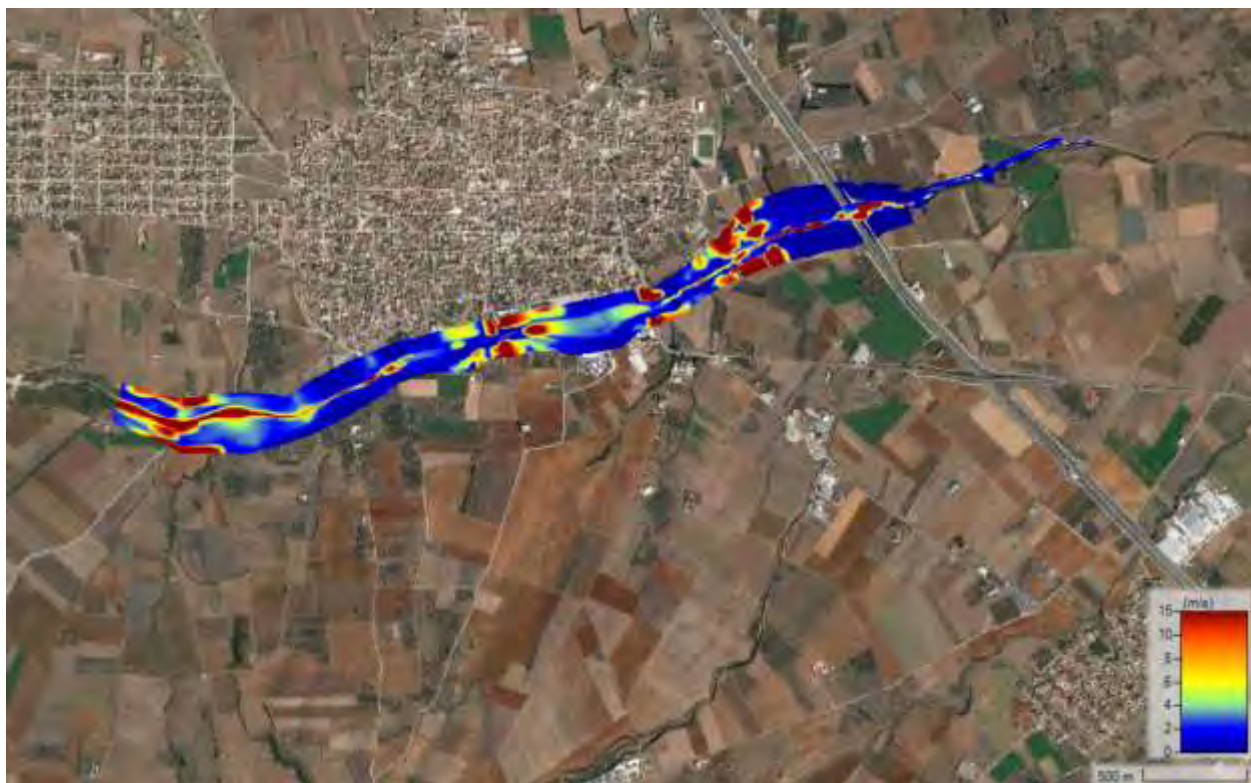
Σχήμα 110 Χάρτης ταχυτήτων ροής για T=1000 δυσμενής συνθήκες
