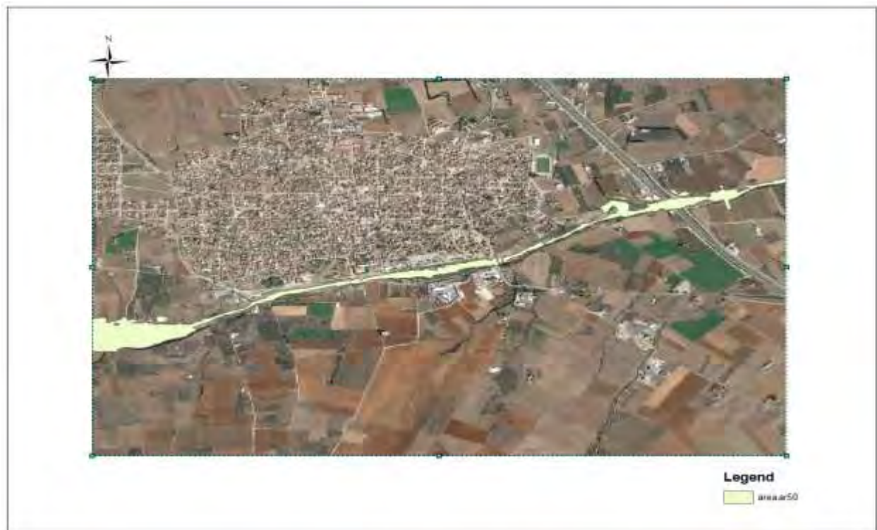
Σχήμα 65 Χάρτης συνολικής έκτασης πλημμύρας T=50 μέσες συνθήκες
