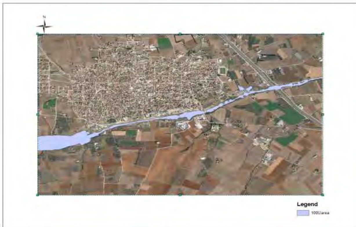
Σχήμα 103 Χάρτης συνολικής έκτασης πλημμύρας T=1000 δυσμενής συνθήκες
