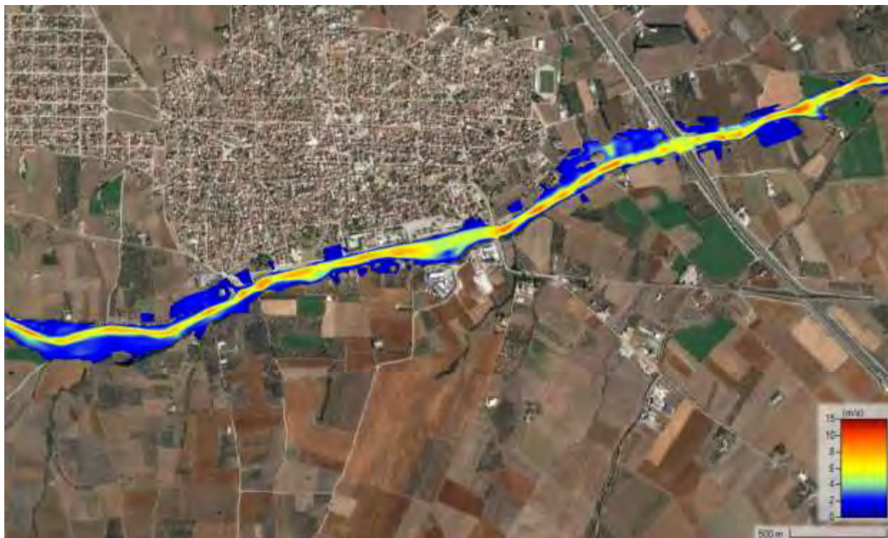
Σχήμα 82 Χάρτης ταχυτήτων ροής T=100 δυσμενής συνθήκες
