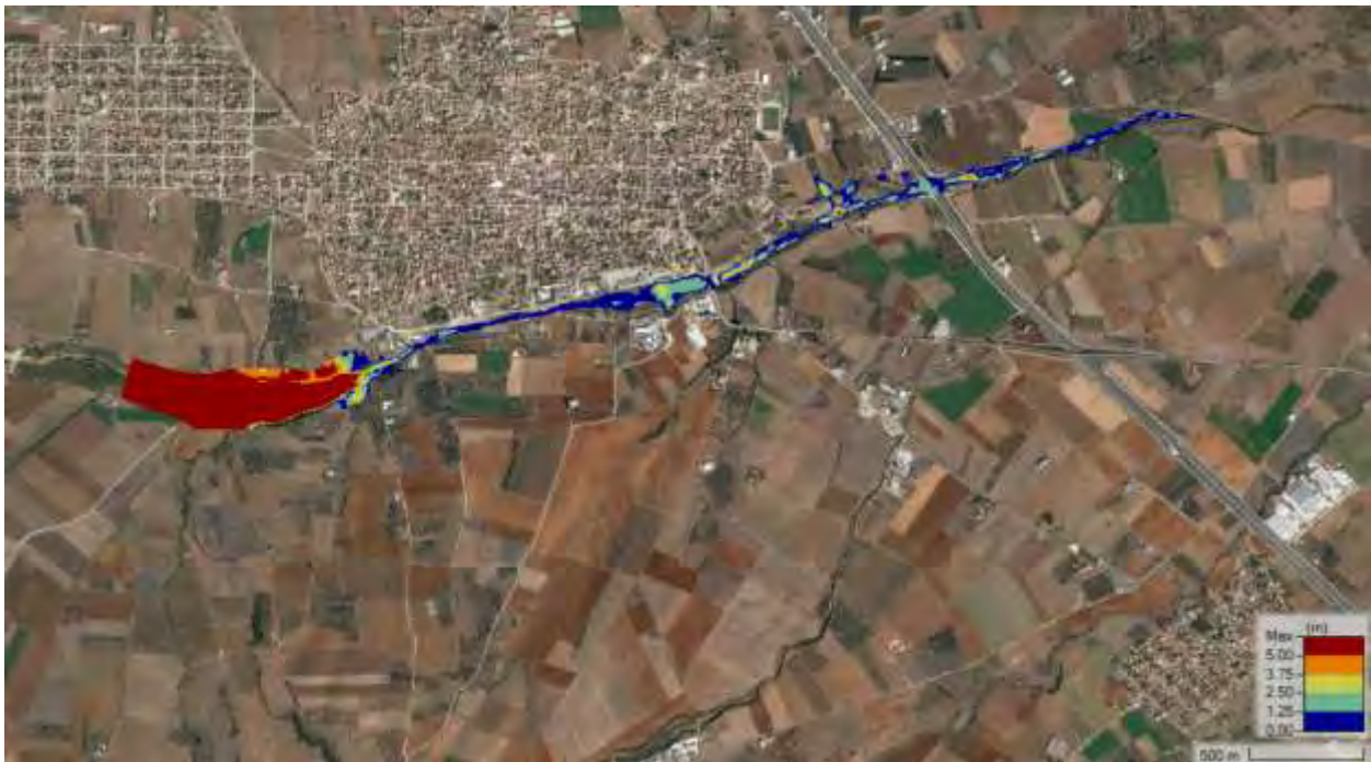
Σχήμα 101 Χάρτης βαθών ροής για T=100 δυσμενής συνθήκες
