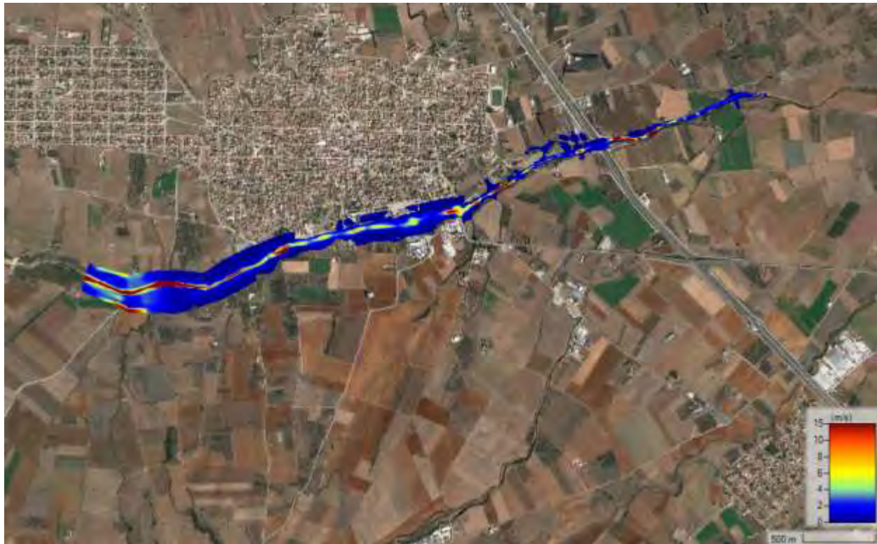
Σχήμα 63 Χάρτης ταχυτήτων ροής T=1000 μέσες συνθήκες
