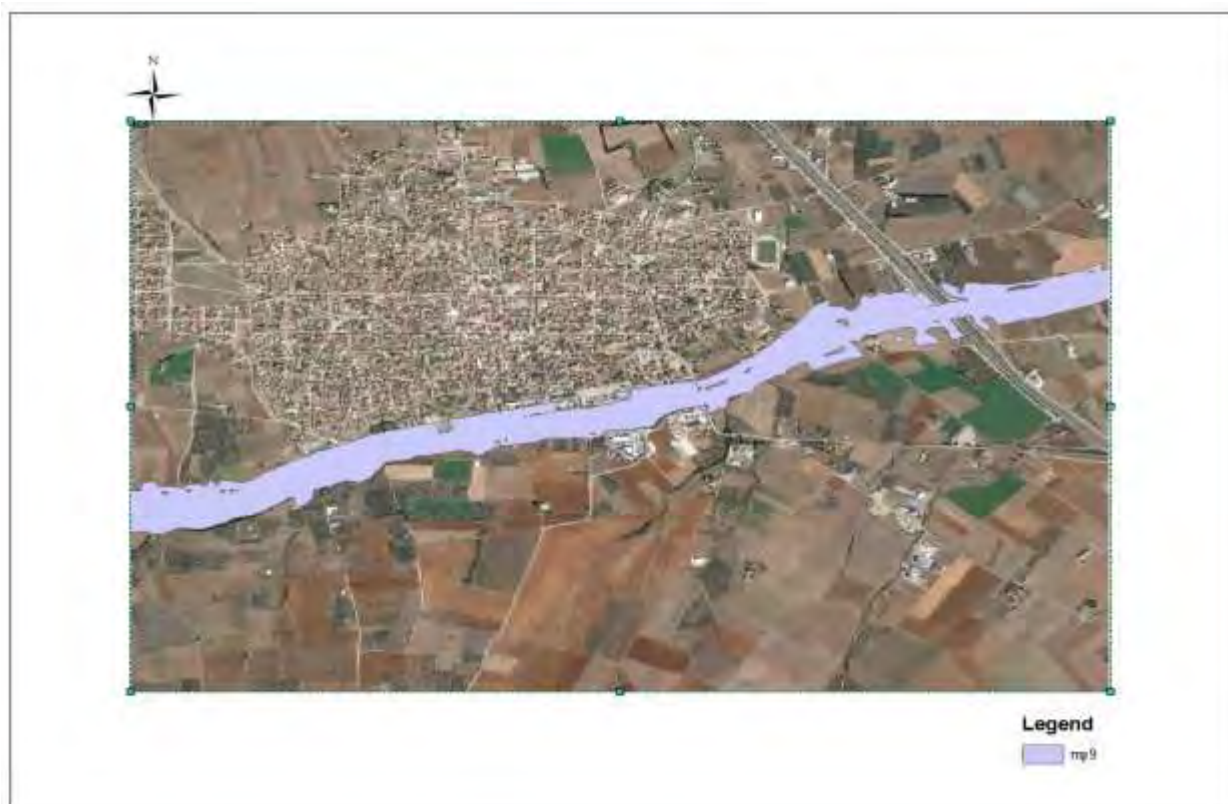
Σχήμα 91 Χάρτης συνολικής έκτασης πλημμύρας T=1000 δυσμενής συνθήκες
