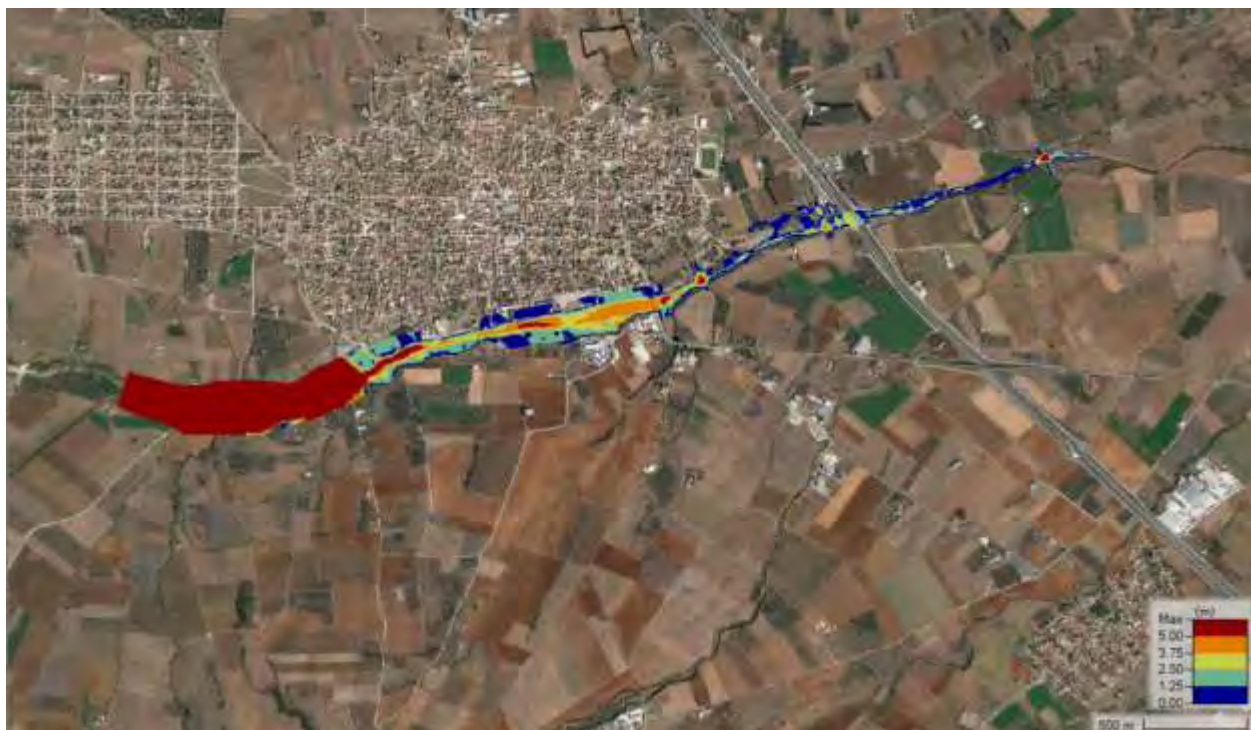
Σχήμα 59 Χάρτης βαθών πλημμύρας T=1000 μέρες συνθήκες
