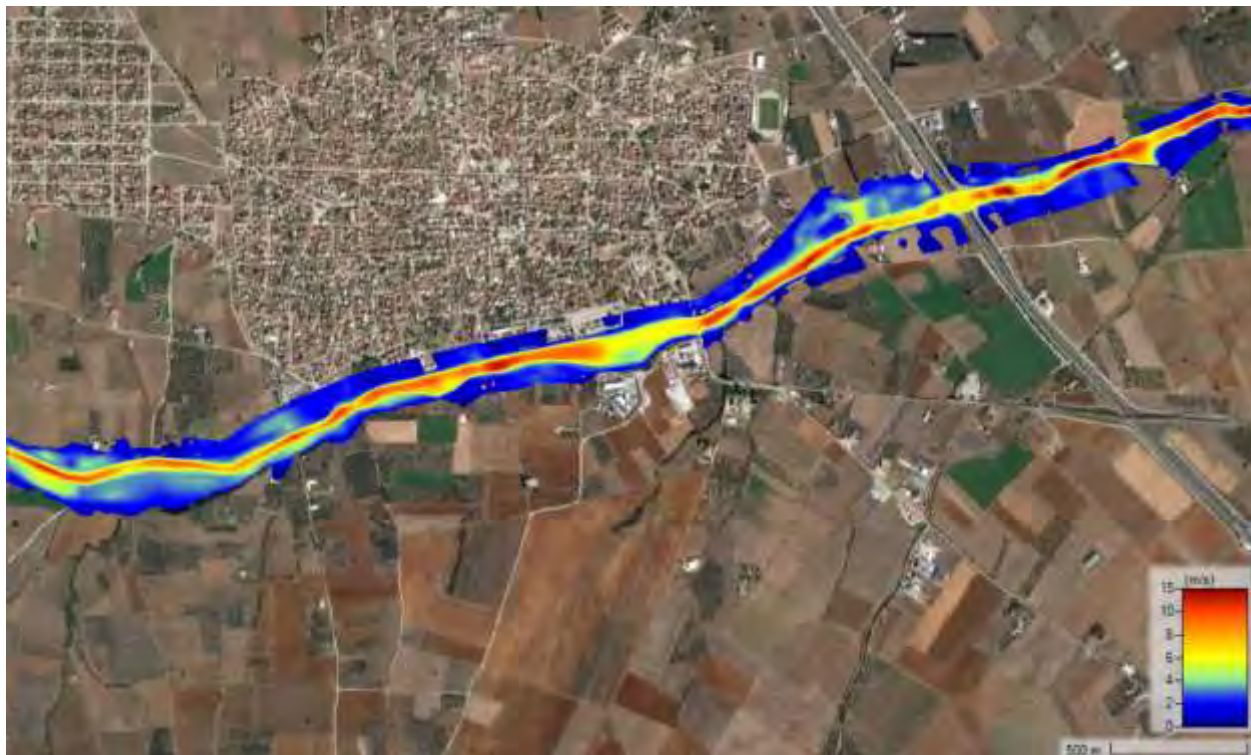
Σχήμα 90 Χάρτης ταχυτήτων ροής T=1000 δυσμενής συνθήκες
