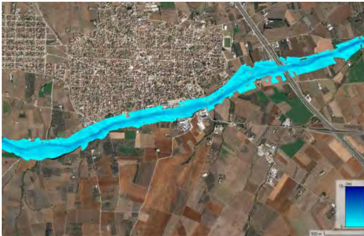
Σχήμα 88 Χάρτης κατακλισμένης περιοχής για T=1000 δυσμενής συνθήκες
