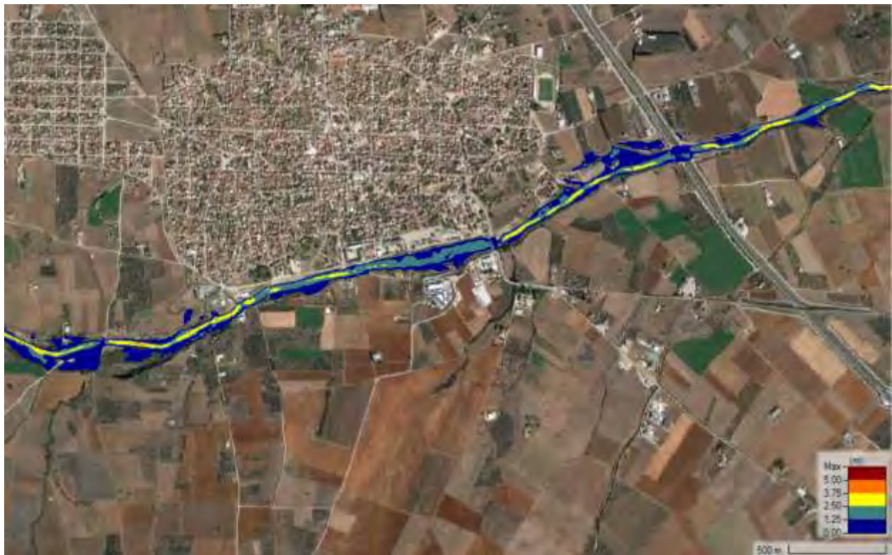
Σχήμα 41 Χάρτης βαθών ροής T=50 μέσες συνθήκες
