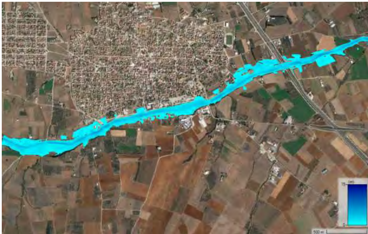
Σχήμα 80 Χάρτης κατακλισμένης περιοχής για T=100 δυσμενής συνθήκες
