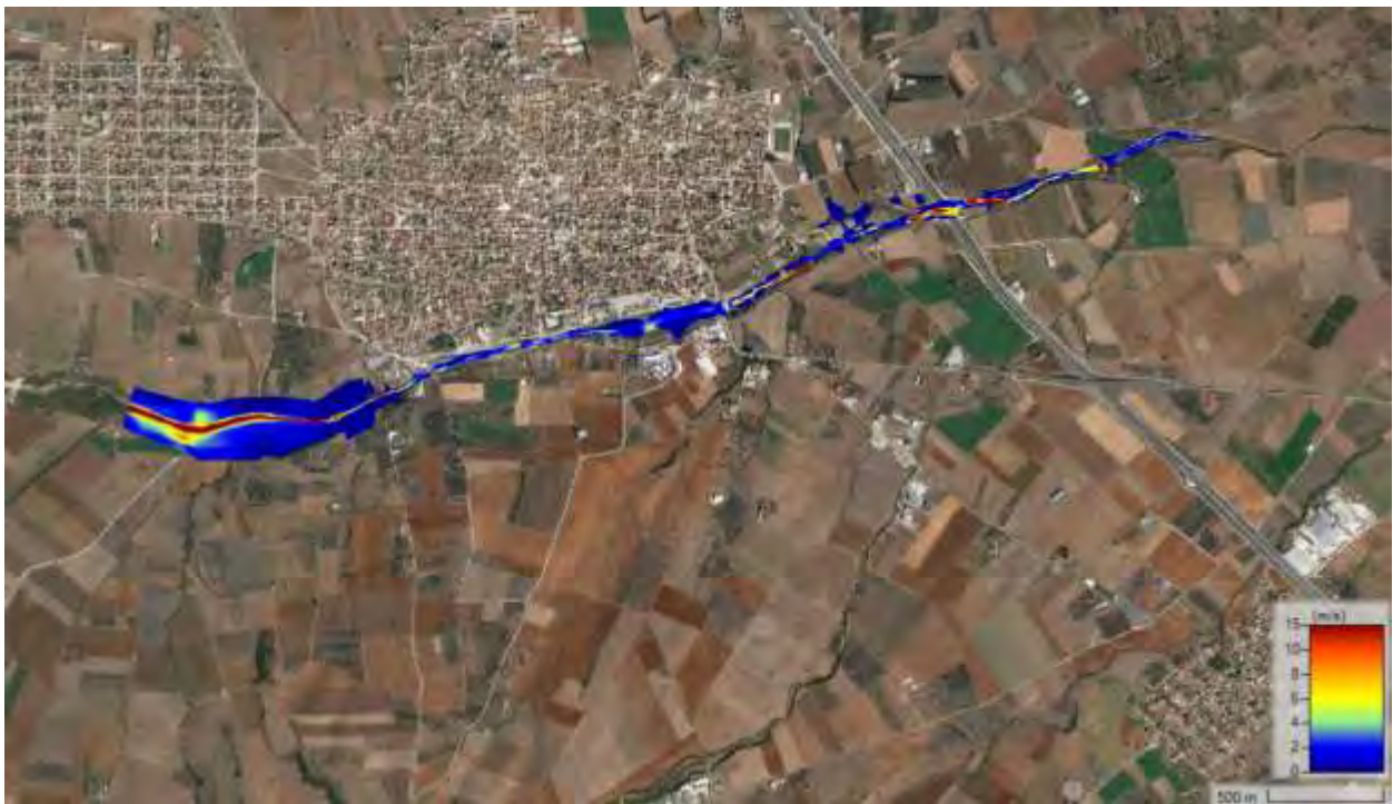
Σχήμα 102 Χάρτης ταχυτήτων ροής για T=100 δυσμενής συνθήκες
