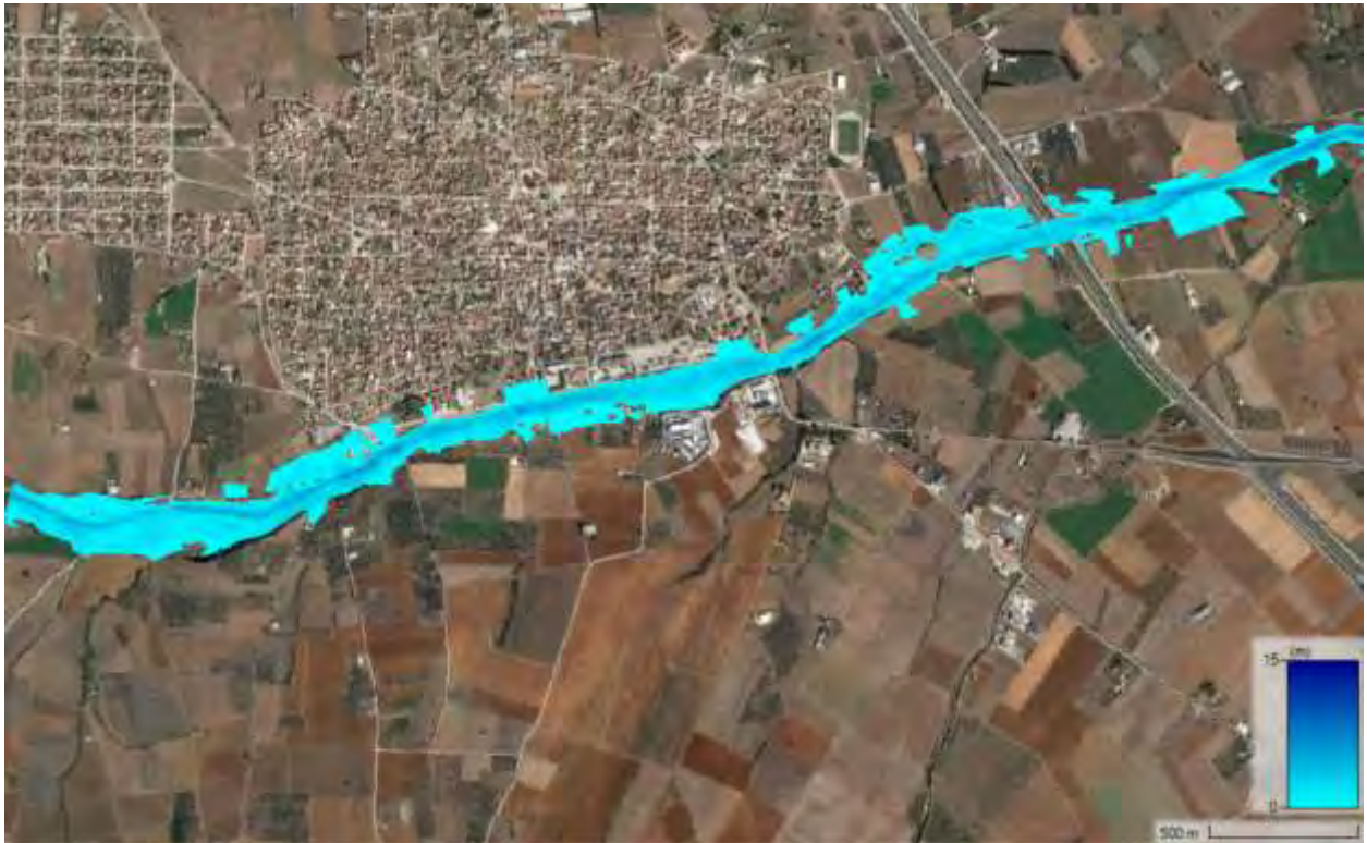
Σχήμα 39 Χάρτης πλημμυρικής κατάκλισης T=1000 μέσες συνθήκες
