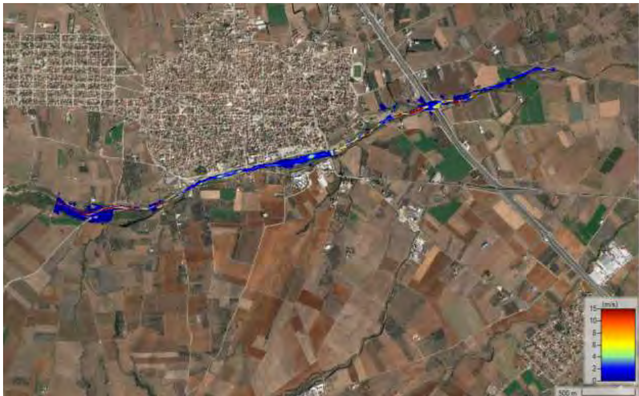
Σχήμα 60 Χάρτης ταχυτήτων ροής T=50 ευμενής συνθήκες
