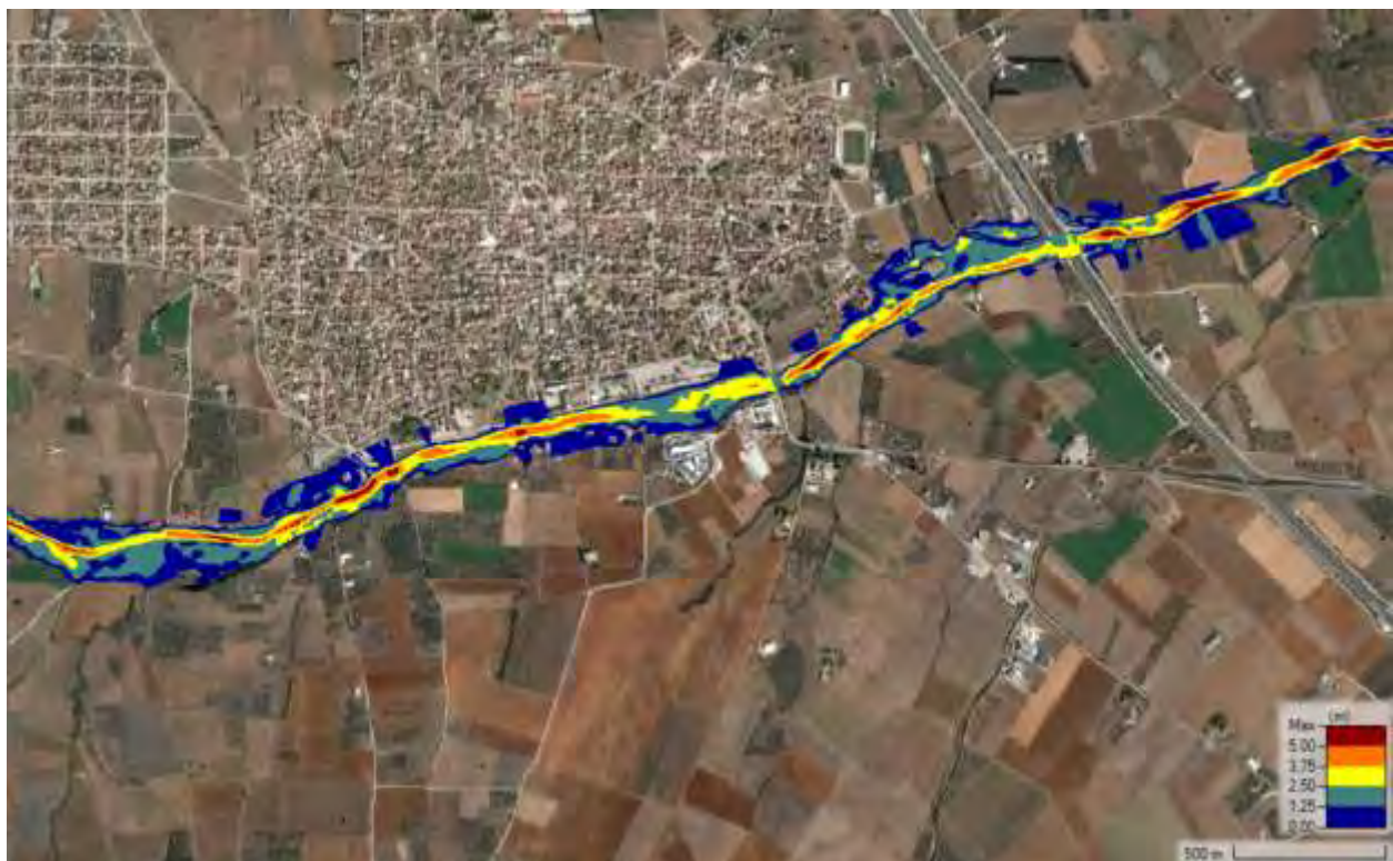
Σχήμα 43 Χάρτης βάθος ροής T=1000 μέσες συνθήκες
