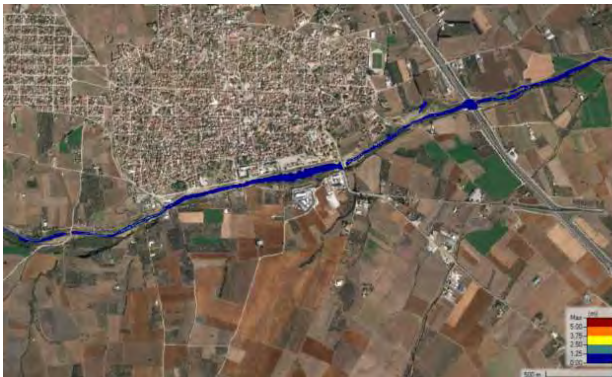
Σχήμα 77 Χάρτης βάθους ροής για T=100 ευμενής συνθήκες
