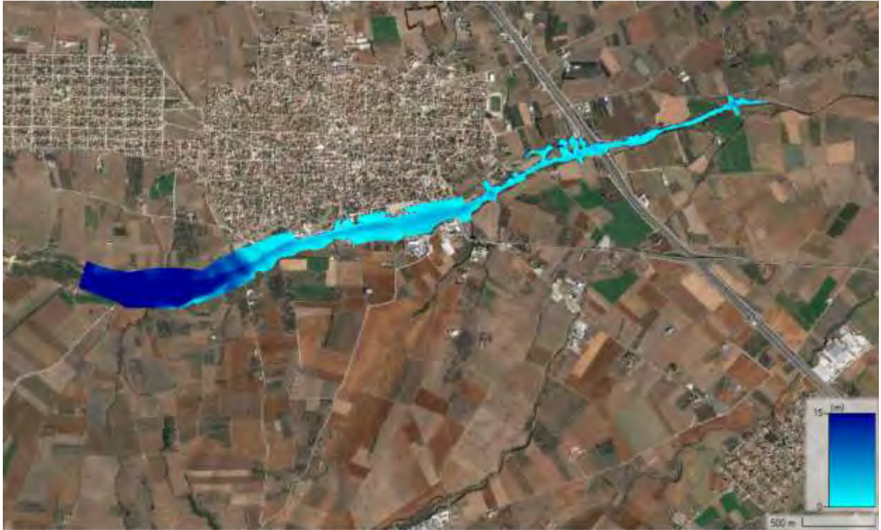
Σχήμα 55 Χάρτης κατακλισμένης περιοχής για T=1000 μέσες συνθήκες
