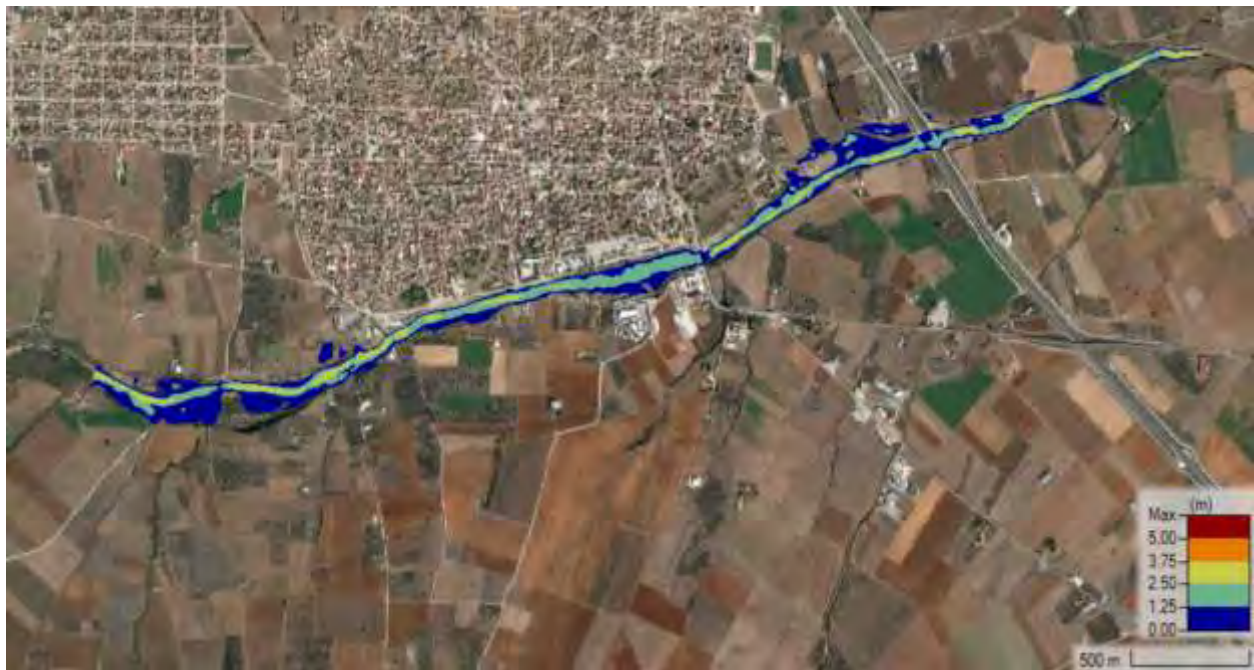
Σχήμα 42 Χάρτης βάθος ροής T=100 μέσες συνθήκες
