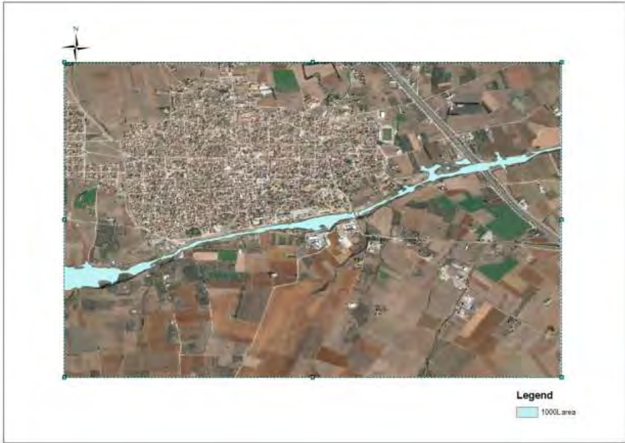
Σχήμα 107 Χάρτης συνολικής έκτασης πλημμύρας T=1000 ευμενής συνθήκες
