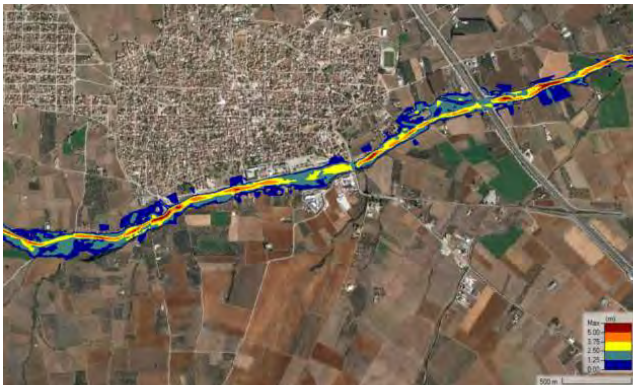
Σχήμα 81 Χάρτης βάθους ροής για T=100 δυσμενής συνθήκες
