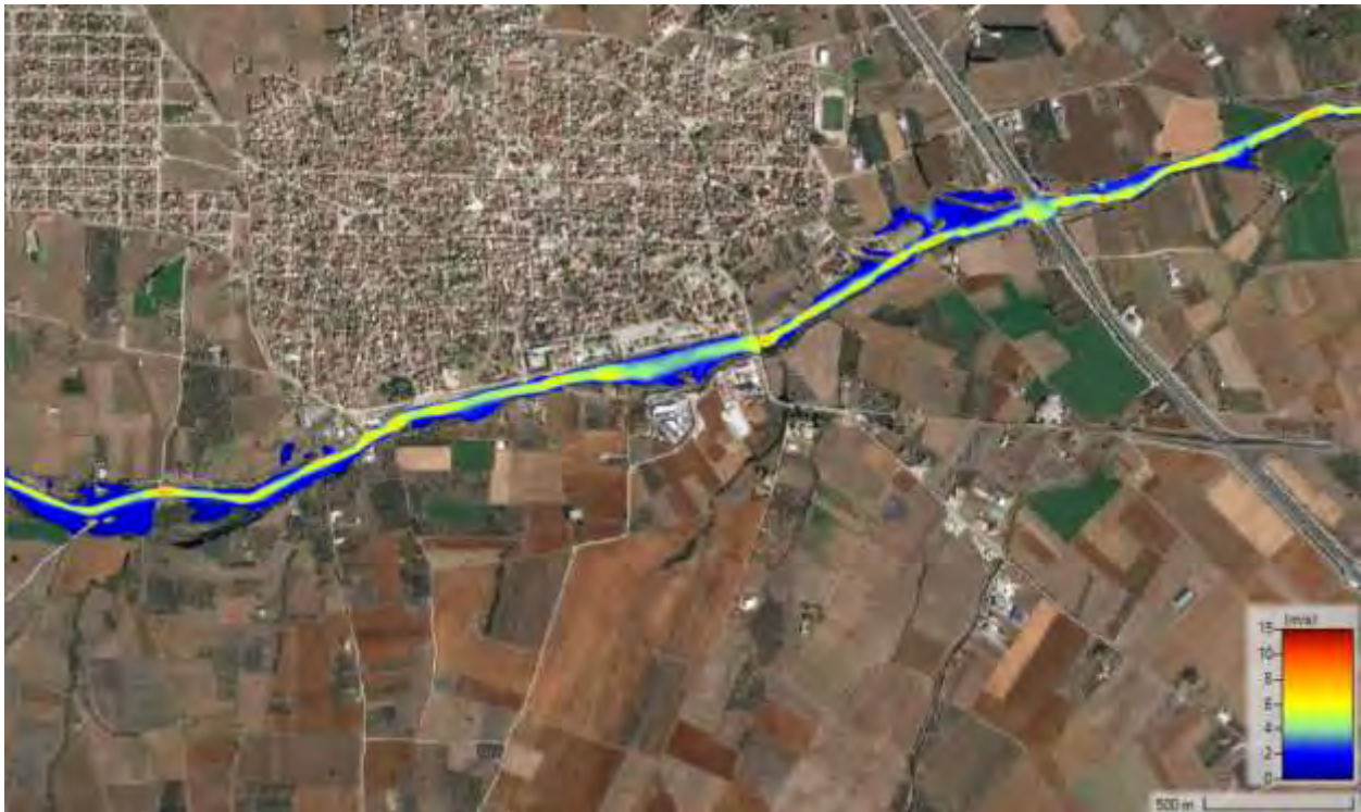
Σχήμα 45 Χάρτης ταχυτήτων ροής T=50 μέσες συνθήκες
