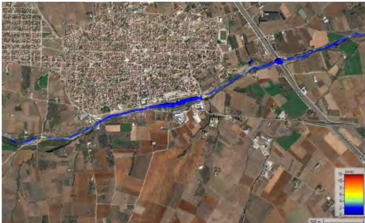
Σχήμα 44 Χάρτης ταχυτήτων ροής T=50 ευμενής συνθήκες
