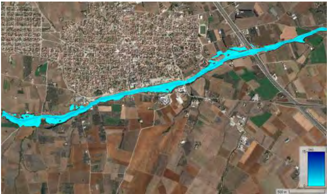
Σχήμα 38 Χάρτης πλημμυρικής κατάκλισης T=100 μέρες συνθήκες
