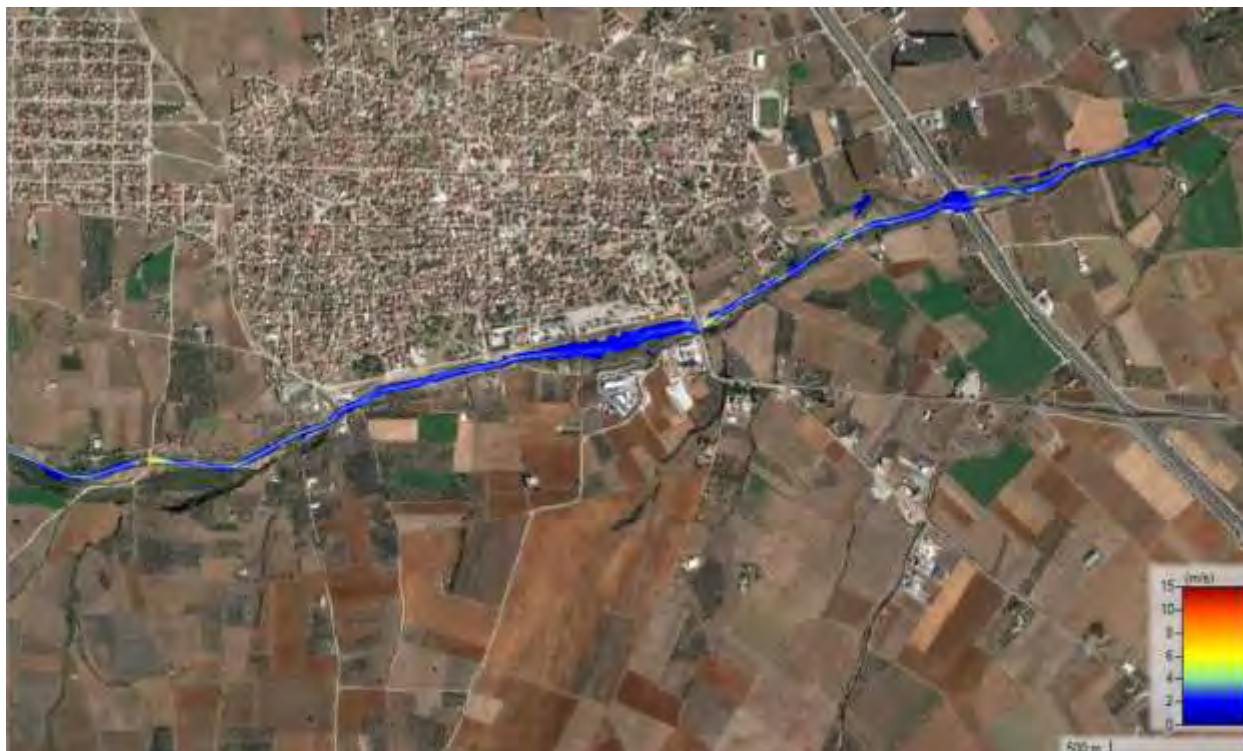
Σχήμα 78 Χάρτης ταχυτήτων ροής T=100 ευμενής συνθήκες
