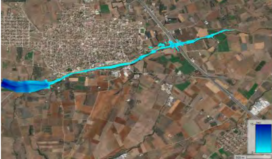
Σχήμα 92 Χάρτης κατακλισμένης περιοχής για T=50 δυσμενής συνθήκες
