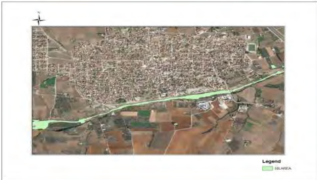
Σχήμα 64 Χάρτης συνολικής έκτασης πλημμύρας T=50 ευμενής συνθήκες
