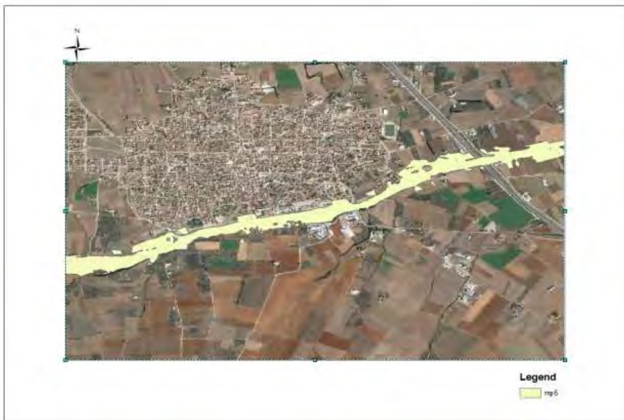
Σχήμα 83 Χάρτης συνολικής έκτασης πλημμύρας T=100 δυσμενής συνθήκες
