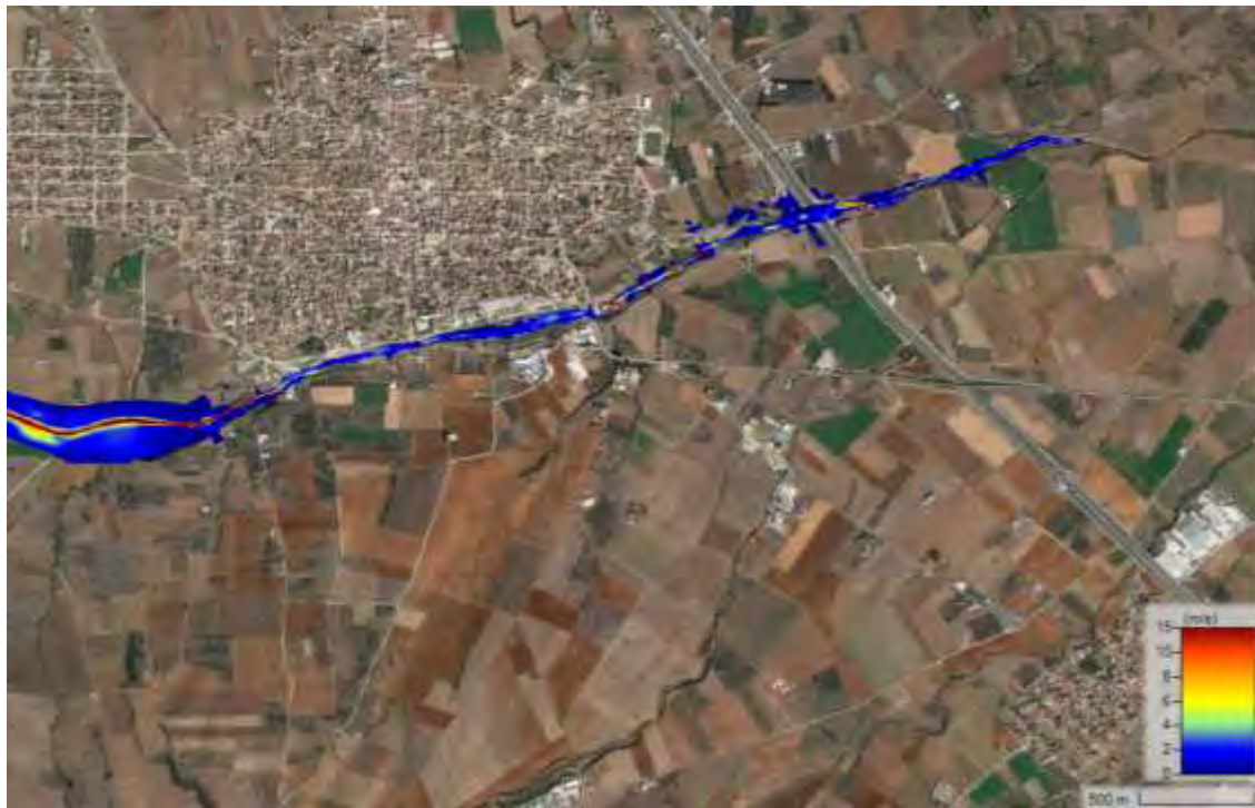
Σχήμα 94 Χάρτης ταχυτήτων ροής T=50 δυσμενής συνθήκες
