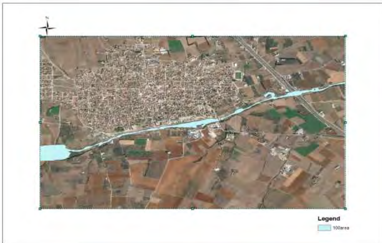
Σχήμα 66 Χάρτης συνολικής έκτασης πλημμύρας T=100 μέσες συνθήκες
