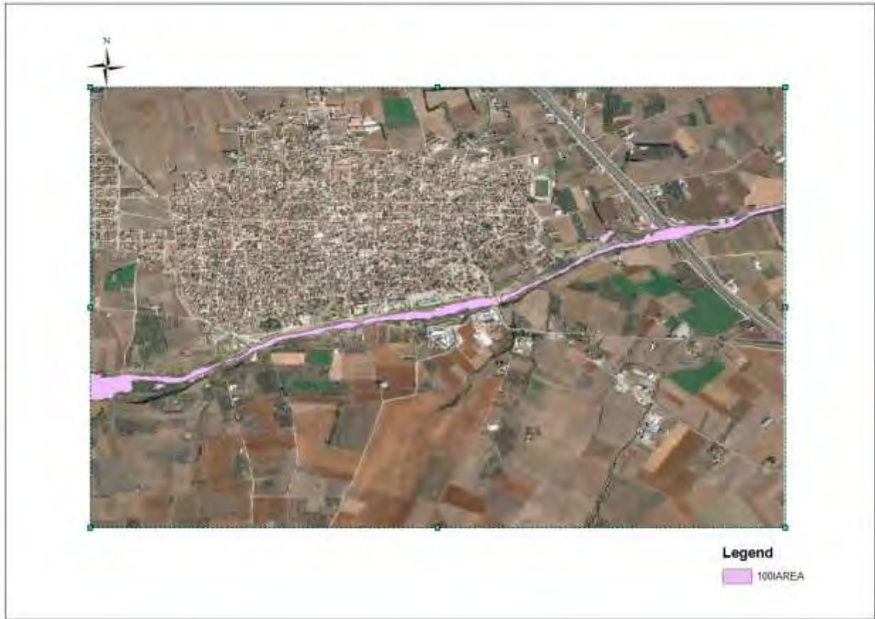
Σχήμα 99 Χάρτης συνολικής έκτασης πλημμύρας T=100 ευμενής συνθήκες
