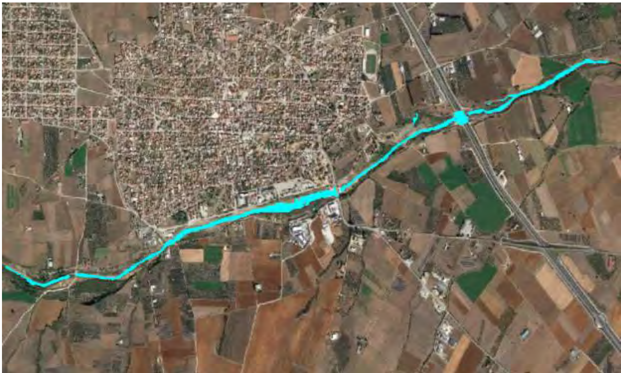
Σχήμα 36 Χάρτης πλημμυρικής κατάκλισης T=50 ευμενής συνθήκες
