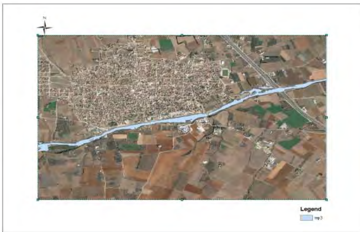
Σχήμα 75 Χάρτης συνολικής έκτασης πλημμύρας T=50 δυσμενής συνθήκες
