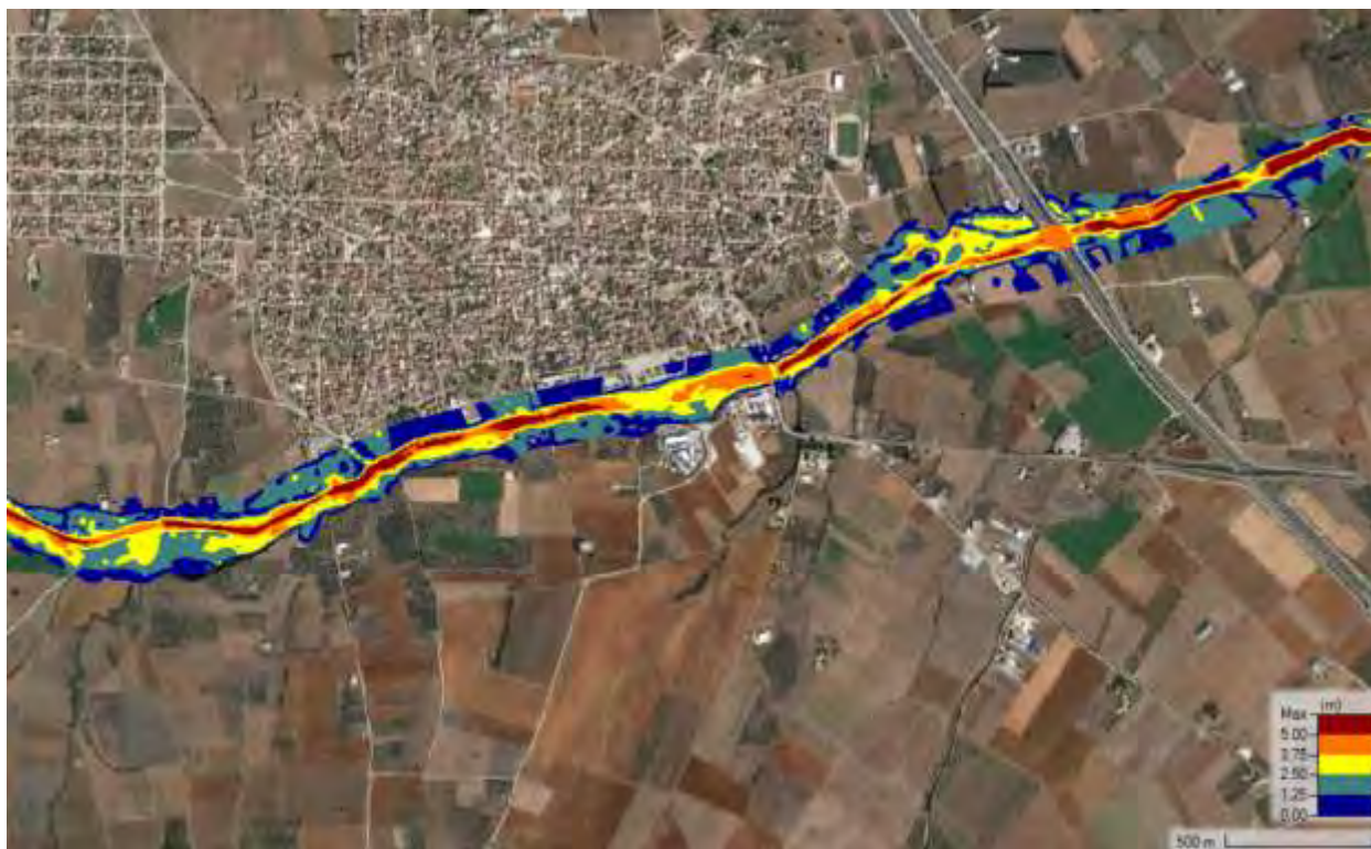
Σχήμα 89 Χάρτης βάθους ροής για T=1000 δυσμενής συνθήκες
