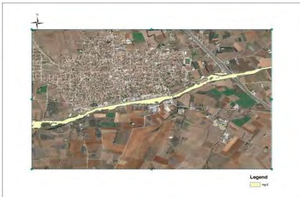
Σχήμα 79 Χάρτης συνολικής έκτασης πλημμύρας T=100 ευμενής συνθήκες
