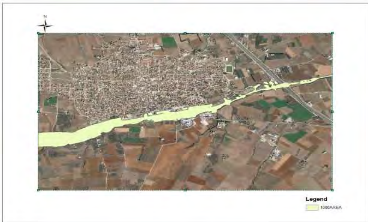
Σχήμα 67 Χάρτης συνολικής έκτασης πλημμύρας T=1000 μέσες συνθήκες
