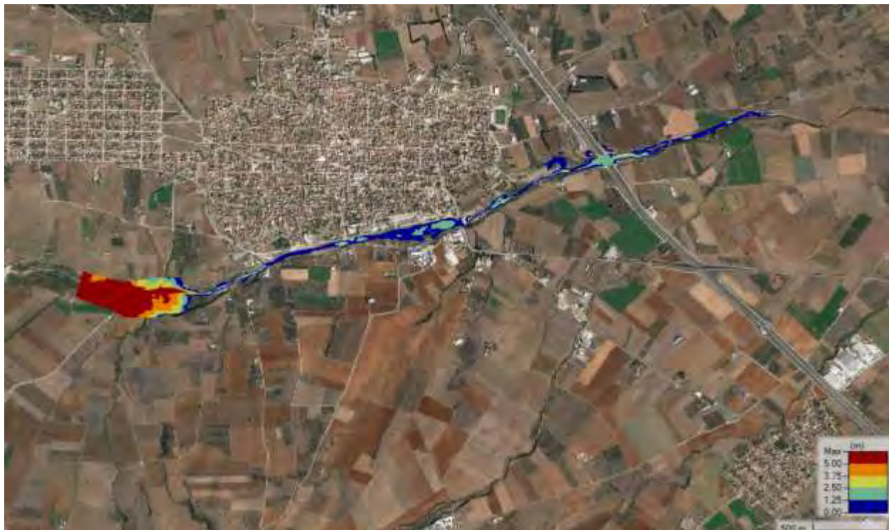
Σχήμα 58 Χάρτης βαθών πλημμύρας T=100 μέρες συνθήκες
