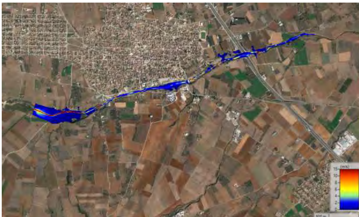
Σχήμα 106 Χάρτης ταχυτήτων ροής για T=1000 ευμενής συνθήκες
