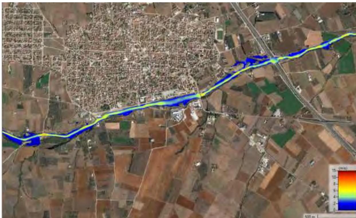
Σχήμα 86 Χάρτης ταχυτήτων ροής T=1000 ευμενής συνθήκες
