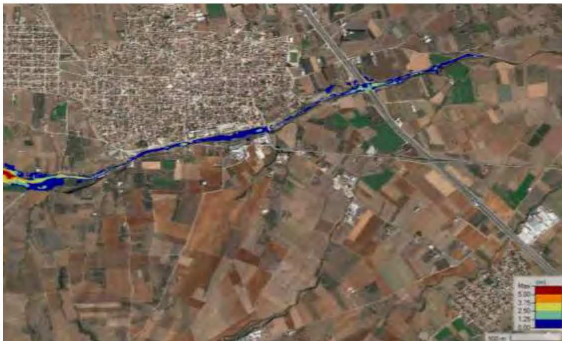
Σχήμα 97 Χάρτης βαθών ροής για T=100 ευμενής συνθήκες
