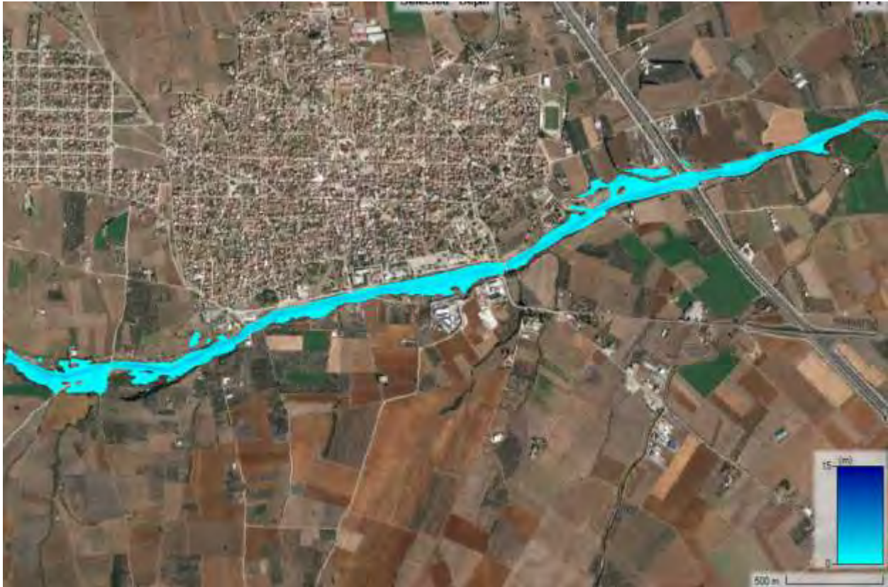
Σχήμα 37 Χάρτης πλημμυρικής κατάκλισης T=50 μέρες συνθήκες
