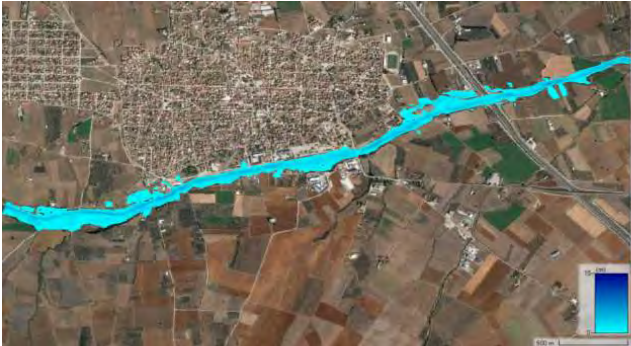
Σχήμα 72 Χάρτης κατακλισμένης περιοχής για T=50 δυσμενής συνθήκες
