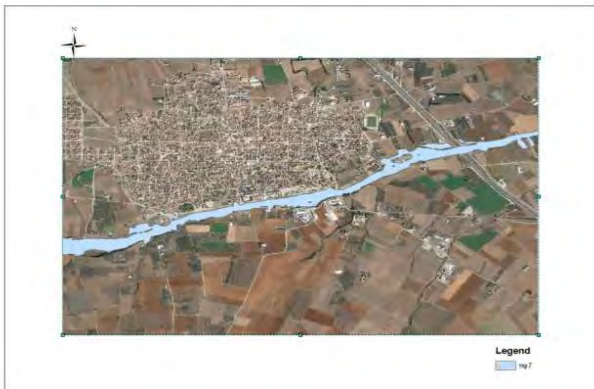
Σχήμα 87 Χάρτης συνολικής έκτασης πλημμύρας T=1000 ευμενής συνθήκες
