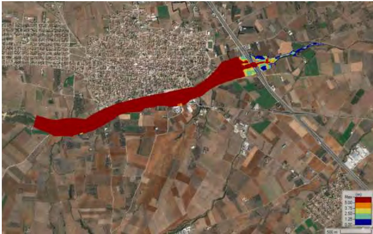
Σχήμα 109 Χάρτης βαθών ροής για T=1000 δυσμενής συνθήκες
