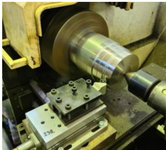
Εικόνα 4.5 Το τεμάχιο, τοποθετημένο στο τσοκ, και το κοπτικό εργαλείο κατά την διάρκεια της κατεργασίας.
