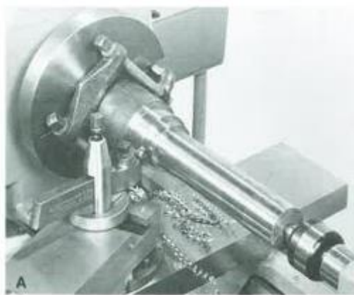
Εικόνα 3.7 Κατεργαζόμενο τεμάχιο συγκρατούμενο μεταξύ των κέντρων του τέρνου. [9]
