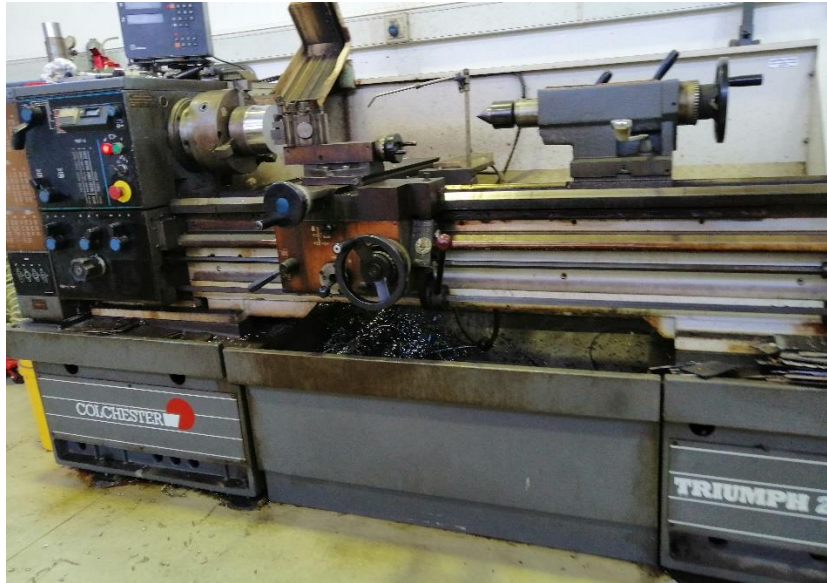
Εικόνα 4.4 Ο τόρνος τύπου Triumph 2500 της Colchester.
