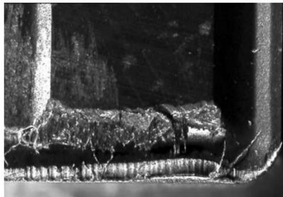
Εικόνα 2.3 Φθορά κρατήρα σε κοπτικό εργαλείο από καρβίδιο σε κοπή κράματος νικελίου. [4]
