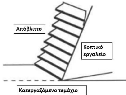
Σχήμα 2.13 Σχηματική αναπαράσταση πριονωτού αποβλίττου. [4]
