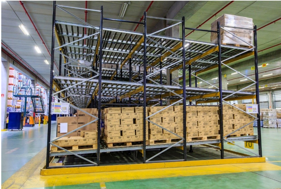
Εικόνα 6: Κεκλιμένα Ράφια (Live Storage)
