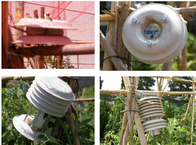
Εικόνα 27: Διάφοροι συνδυασμοί μεταξύ καταγραφέων Hobo και προστατευτικών "πίτων". Οι δύο συνδυασμοί στο πάνω τμήμα προτιμώνται για περιπτώσεις που οι καταγραφείς βρίσκονται υπό την προστασία δίχτων, ενώ οι δυο συνδυασμοί στο κάτω μέρος της εικόνας προτιμώνται για περιπτώσεις μη ύπαρξης δίχτων.
