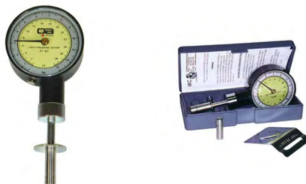
Εικόνα 30: Πενετρόμετρο με προσαρτημένο "διακορευτή" για μέτρηση της αντίστασης σάρκας σε τομάτα (αριστερά) και πλήρες σετ οργάνου με "διακορευτές" για διάφορους τύπους καρπών.
