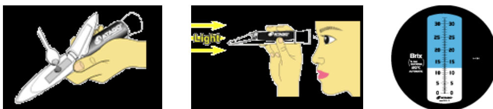
Εικόνα 32: Μέθοδος λήψης μετρήσεων από χυμούς φρούτων με διαθλασίμετρο χειρός.
