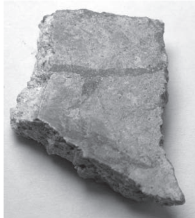
Εικ. 4. Το έγχρωμο κονίαμα με την γραπτή διακόσμηση κόκκινου χρώματος που από αναλύσεις στο XRF μηχάνημα που διαθέτει η ΙΓ΄ ΕΠΚΑ στο εργαστήριο συντήρησης μετάλλων, οι πρώτες ενδείξεις δείχνουν ότι πρόκειται για θειούχο υδράργυρο (HgS) δηλαδή για κινάβαρη.
