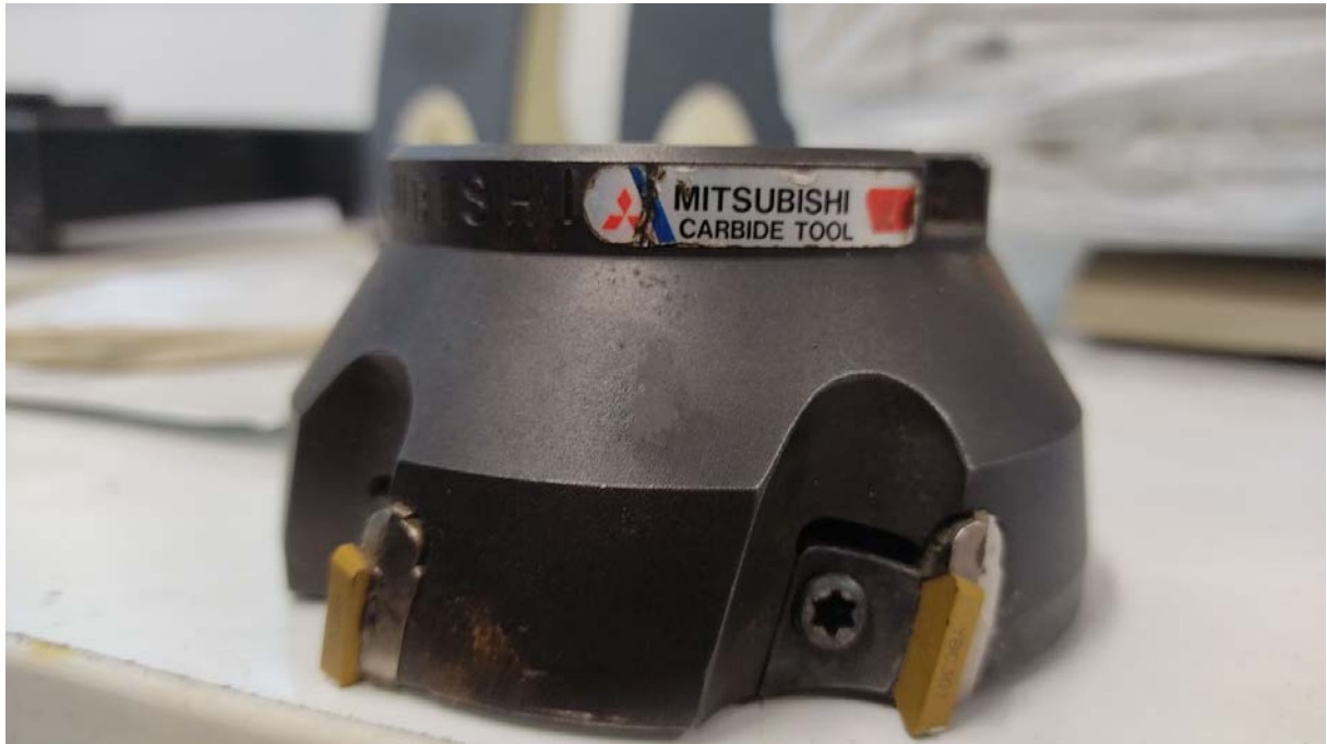
Σχήμα 4.1-2: Η κεφαλή φρέζας Mitsubishi Materials SE300-100A05R.
