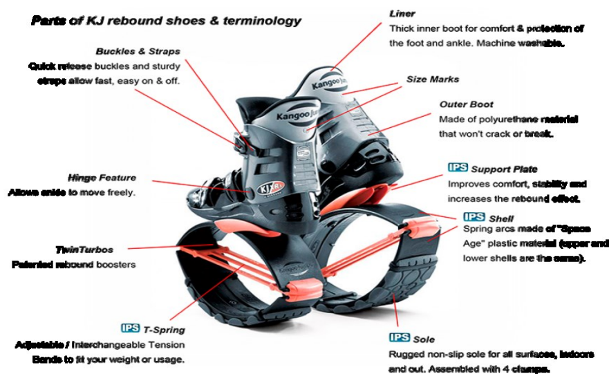
Εικόνα 3. Τα εξαρτήματα της μπότας KJRB και του συστήματος IPS
