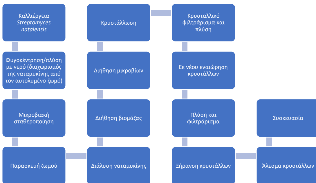
Εικόνα 1. Διάγραμμα ροής της παραγωγής ναταμυκίνης.
