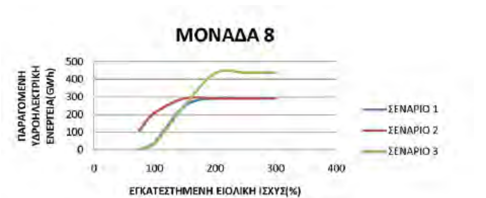
Σχήμα 6.45: Διάγραμμα υδροηλεκτρικής ενέργειας που παράγεται σε συνάρτηση της εγκατεστημένης ισχύος από αιολικά
