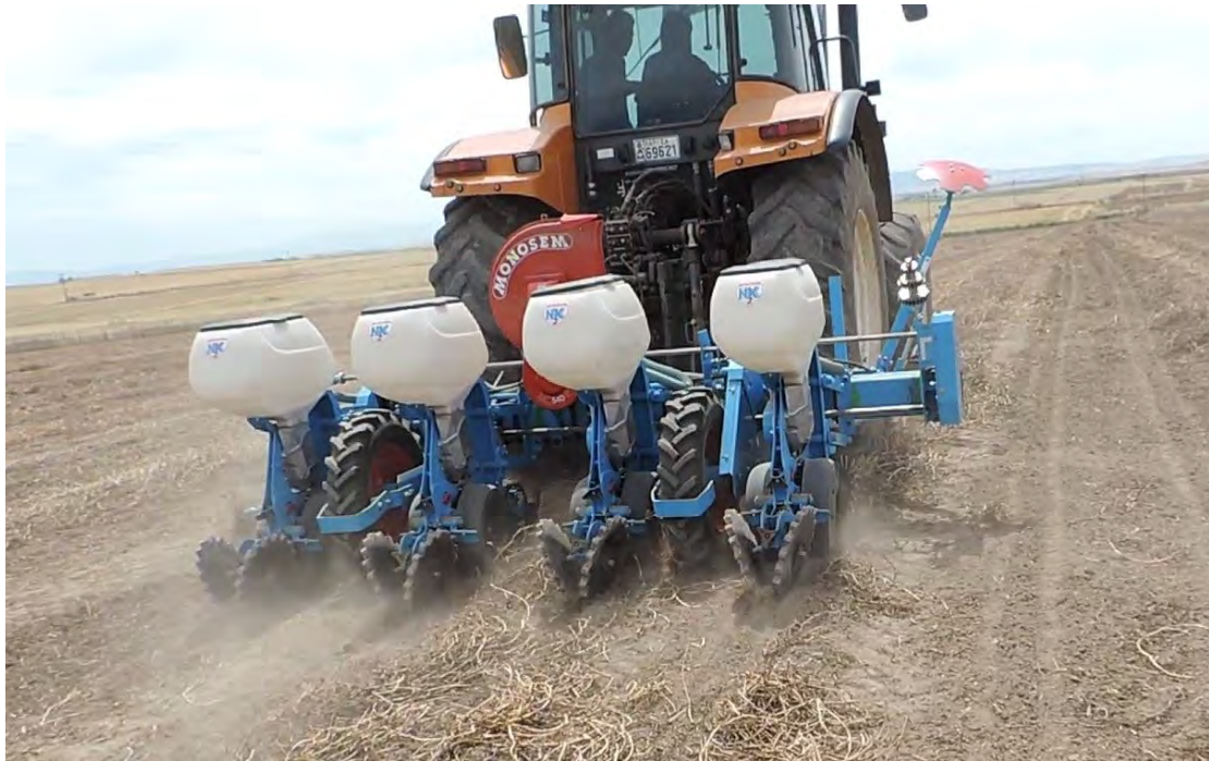
Εικόνα 4: Πνευματική σπαρτική μηχανή ακαλλιέργειας γραμμικών καλλιεργειών.
