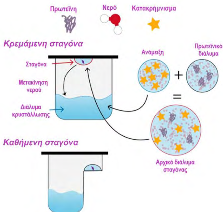
Εικόνα 22: Διάχυση ατμών: η μέθοδος της καθήμενης και της κρεμάμενης σταγόνας. Προσαρμοσμένη εικόνα (108)
