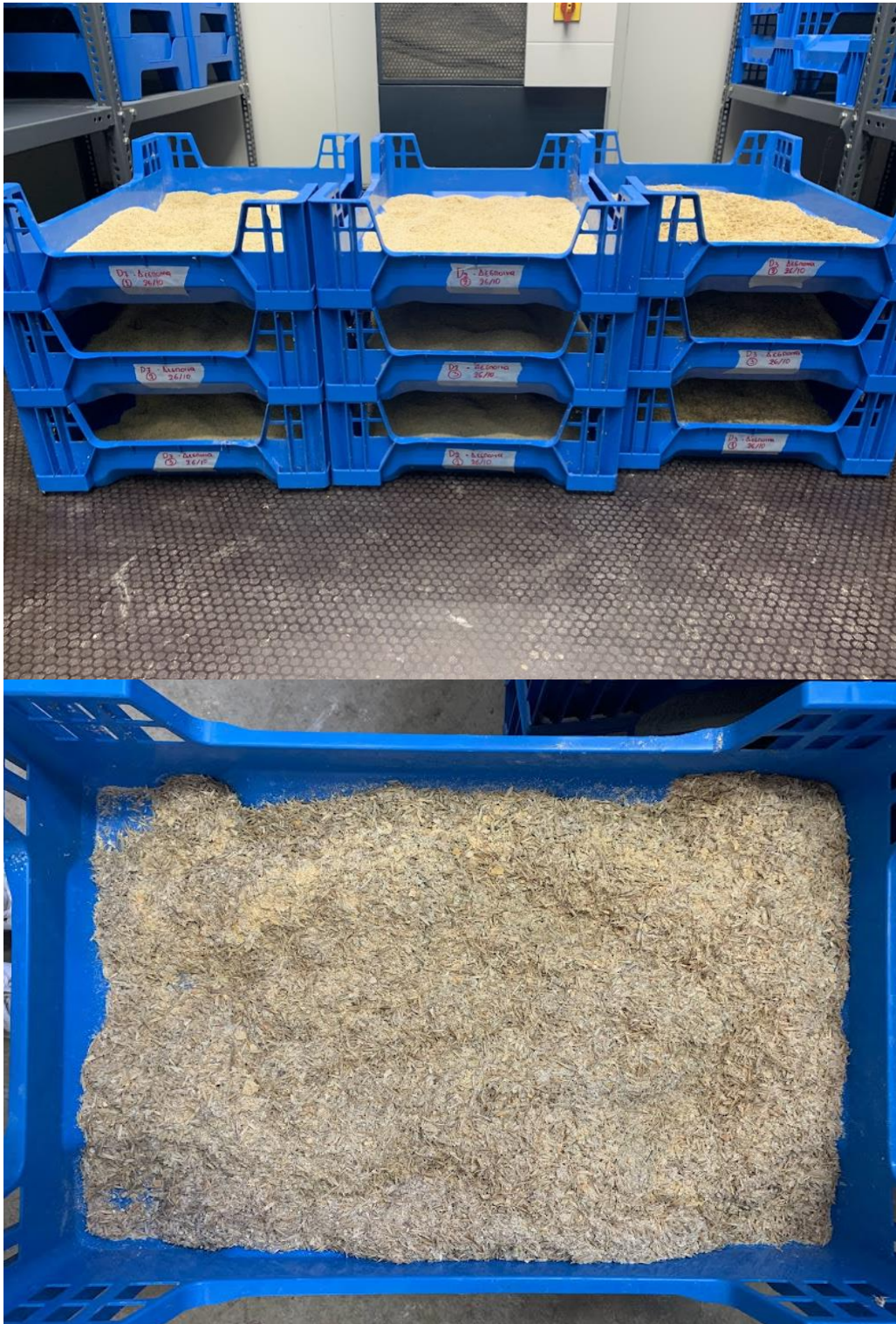
Εικόνα 9 Οι πειραματικές μονάδες (μήκους 60 cm, πλάτους 40 cm και βάθους 14,5 cm) που χρησιμοποιήθηκαν ως πειραματικές μονάδες για την εκτροφή των προνυμφών του είδους Tenebrio molitor σε διαφορετικές δίαιτες.
