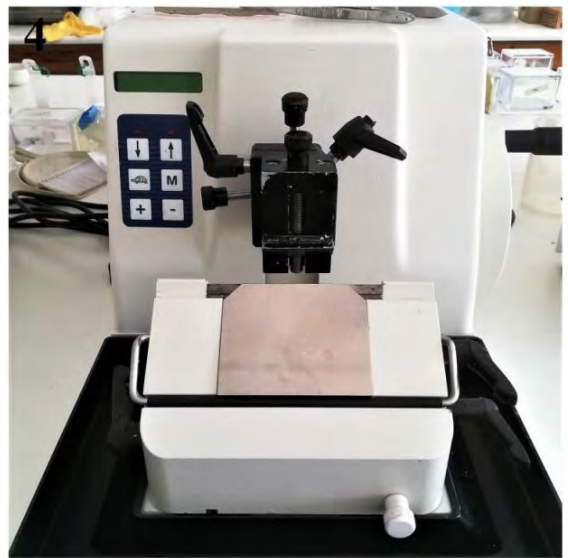
Εικόνα 2.8. Εξοπλισμός ιστολογίας 1: ιστοκινέτα 2: συσκευή σκλήνωσης 3:υδατόλουτρο 4:παλινδρομική μικροτόμος
