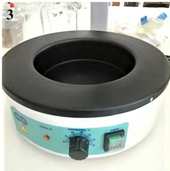
Εικόνα 2.8. Εξοπλισμός ιστολογίας 1: ιστοκινέτα 2: συσκευή σκλήνωσης 3:υδατόλουτρο 4:παλινδρομική μικροτόμος
