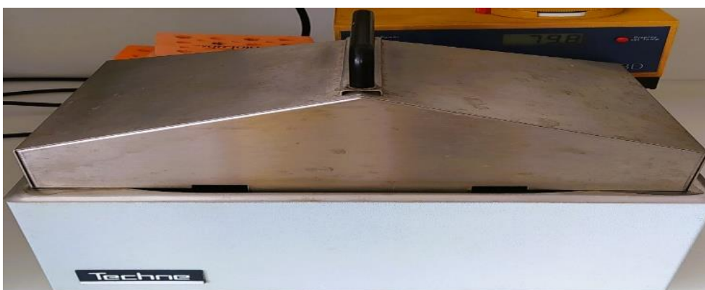
Εικόνα 2.10. Υδατόλουτρο παραμονής του ιστού των φύλλων μέχρι τον πλήρη αποχρωματισμό αυτού.
